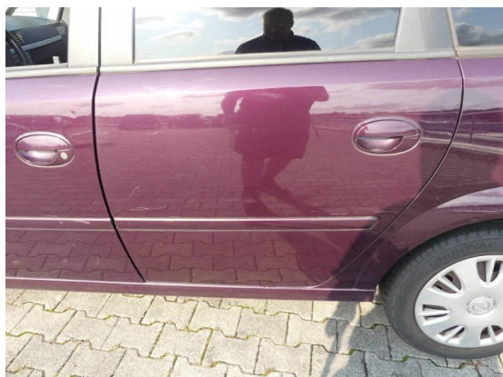
Bild 7: Karosserie / Tür hinten links zerkratzt
