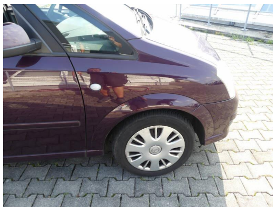
Bild 32: Karosserie / Kotflügel rechts Delle und zerkratzt
