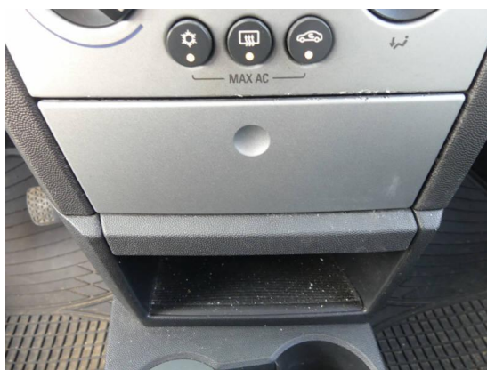
Bild 36: Innenraum / Aschenbecher lässt sich nicht öffnen
