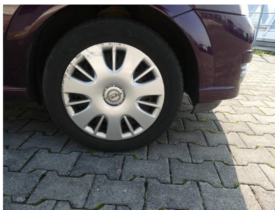
Bild 52: Reifen - Felge / Radkappe vorne rechts zerkratzt
