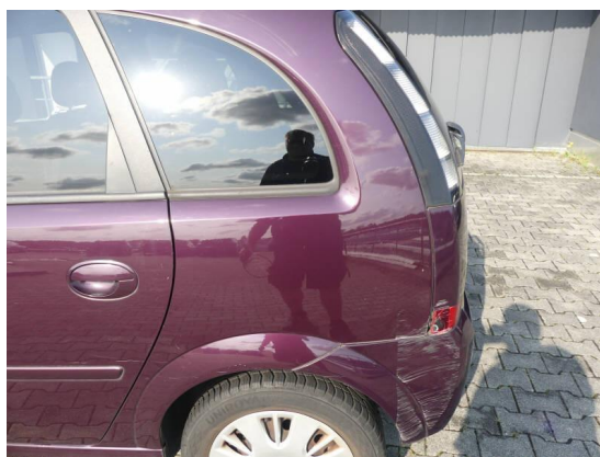
Bild 10: Karosserie / Seitenteil links deformiert und zerkratzt
