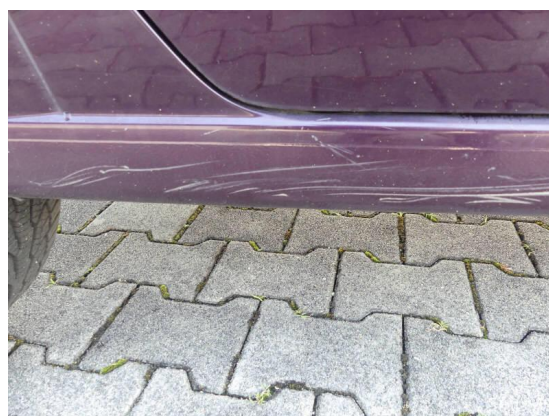
Bild 24: Karosserie / Schweller rechts zerkratzt
