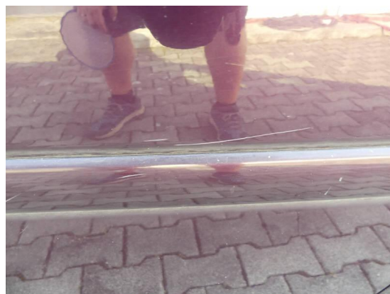
Bild 20: Karosserie / Tür hinten rechts zerkratzt
