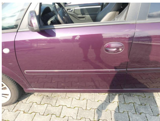
Bild 5: Karosserie / Tür vorne links Dellen und zerkratzt
