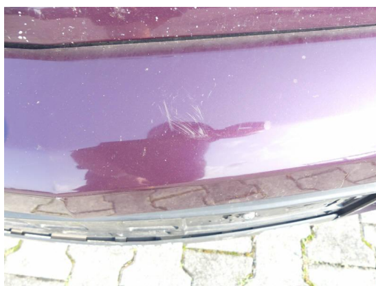
Bild 42: Karosserie / Stoßfänger vorn zekratzt
