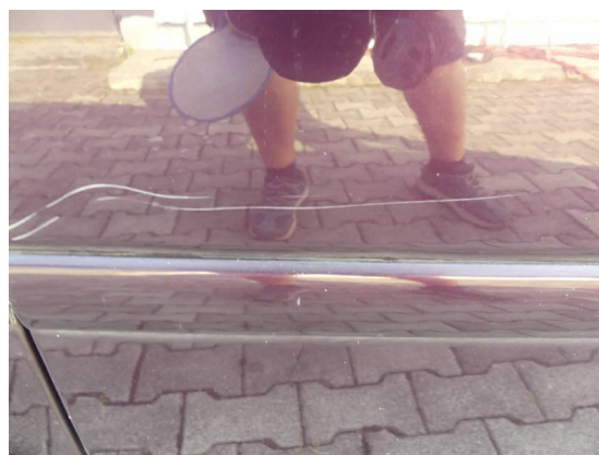
Bild 28: Karosserie / Tür vorne rechts zerkratzt
