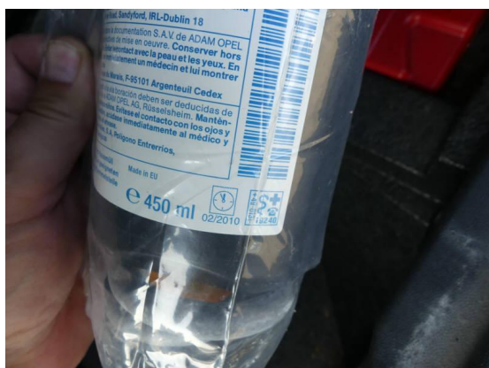
Bild 53: Reifen - Felge / Reifendichtmittel abgelaufen
