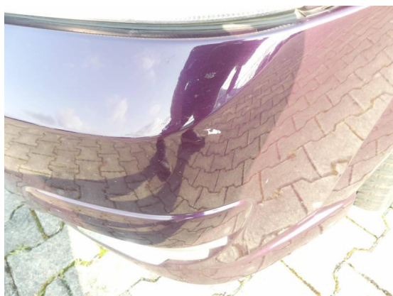
Bild 43: Karosserie / Stoßfänger vorn zekratzt
