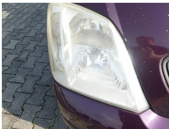
Bild 40: Technik / Scheinwerfer rechts und links matt/blind
