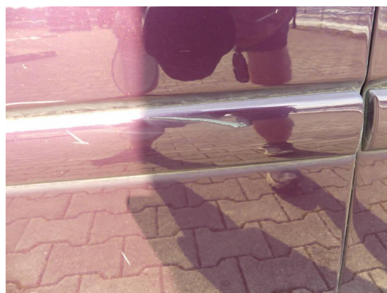
Bild 4: Karosserie / Tür vorne links Dellen und zerkratzt
