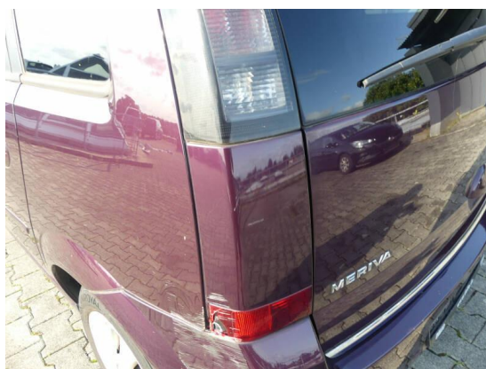
Bild 12: Karosserie / Verkleidung D-Säule links zerkratzt
