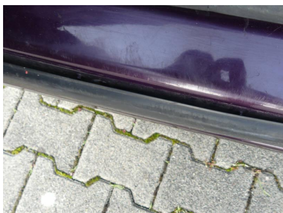
Bild 35: Karosserie / Gummileiste Einstieg vorne links lose
