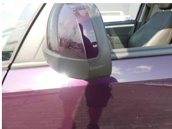
Bild 47: Karosserie / Spiegelkappe links Kratzer
