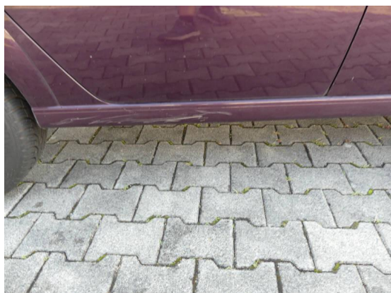
Bild 25: Karosserie / Schweller rechts zerkratzt
