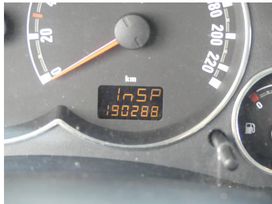
Bild 2: Wartung-Pflege / Wartung fällig
