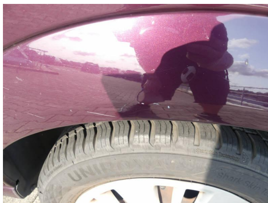
Bild 8: Karosserie / Seitenteil links deformiert und zerkratzt
