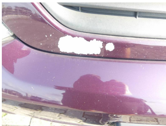
Bild 38: Karosserie / Motorhaube Steinschläge und Lackablösung
