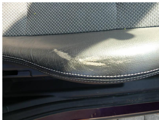
Bild 26: Innenraum / Beifahrersitz Leder verschlissen
