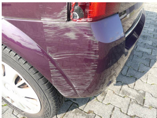
Bild 13: Karosserie / Stoßfänger hinten deformiert und zerkratzt
