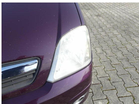
Bild 41: Technik / Scheinwerfer rechts und links matt/blind
