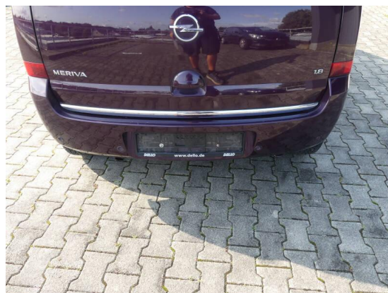
Bild 14: Karosserie / Stoßfänger hinten deformiert und zerkratzt
