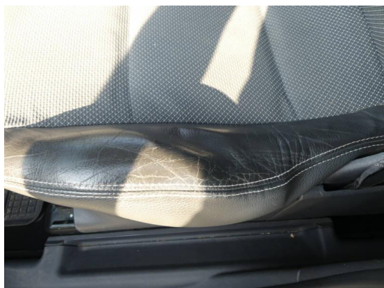
Bild 49: Innenraum / Fahrersitzpolster verschlissen
