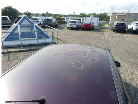
Bild 17: Karosserie / Dach Lackverätzung
