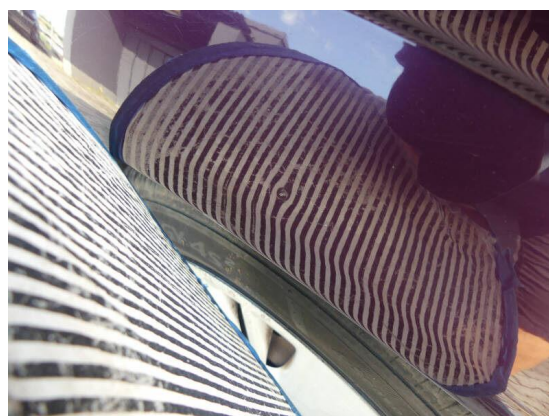
Bild 30: Karosserie / Kotflügel rechts Delle und zerkratzt
