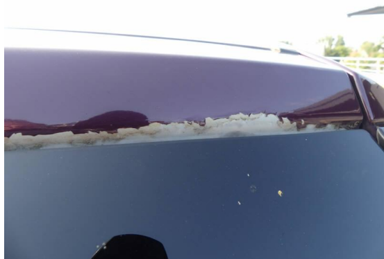
Bild 15: Karosserie / Heckklappe Lackablösung
