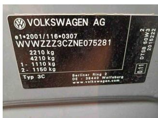
Fahrzeug - Typenschild/Fahrgestellnummer
