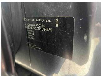
Fahrzeug - Typenschild/Fahrgestellnummer
