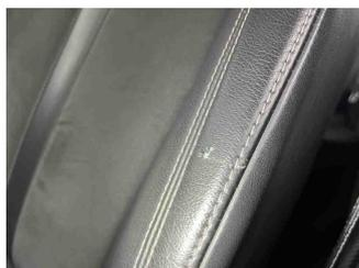
9 - Türzierleiste hinten rechts - Chemische Verunreinigung - Chemische Reinigung
