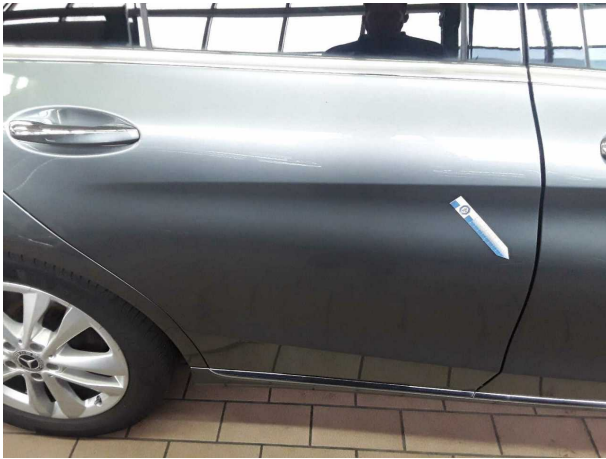
Beschädigung #4: Tür hinten rechts: Tür - Kratzer - lackieren
