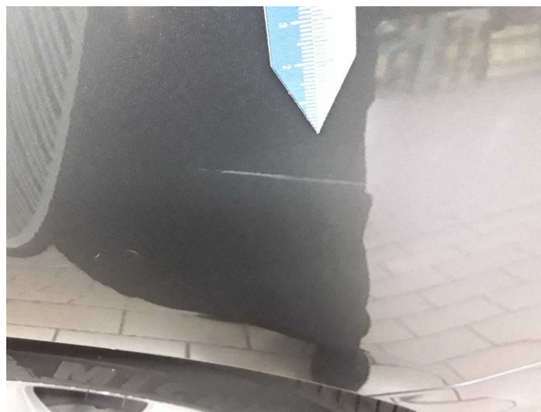
Beschädigung #7: Seitenwand links: Seitenwand - Kratzer - auslegen / polieren
