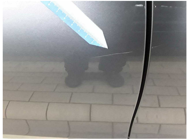
Beschädigung #4: Tür hinten rechts: Tür - Kratzer - lackieren
