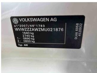
Fahrzeug - Typenschild/Fahrgestellnummer
