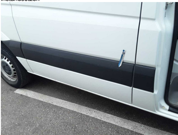
Beschädigung #5: Schiebetür rechts: Schutzleiste - verkratzt / verschürft - erneuern
