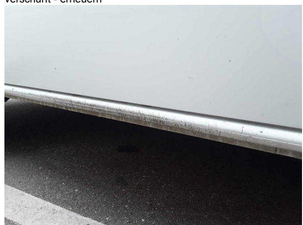
Beschädigung #6: Schweller rechts: Schweller - Kratzer - lackieren
