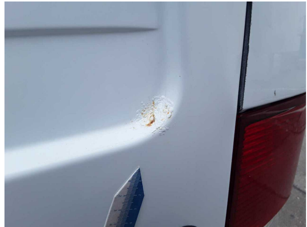
Beschädigung #1: Seitenwand links: Seitenwand - Korrosion - lackieren
