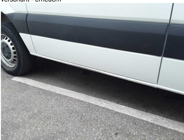
Beschädigung #6: Schweller rechts: Schweller - Kratzer - lackieren
