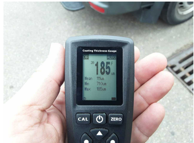
Nachlackierung 5: Seitenwand rechts
