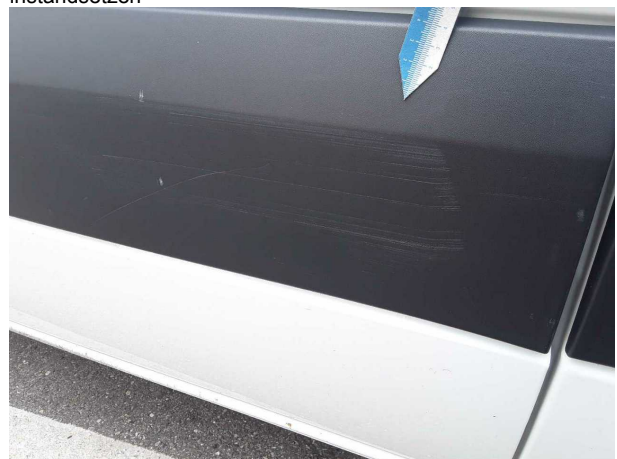
Beschädigung #5: Schiebetür rechts: Schutzleiste - verkratzt / verschürft - erneuern
