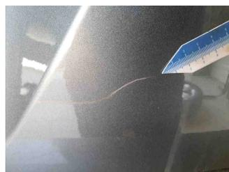
4 - Seitenwand hinten rechts - Kratzer - Smart Repair
