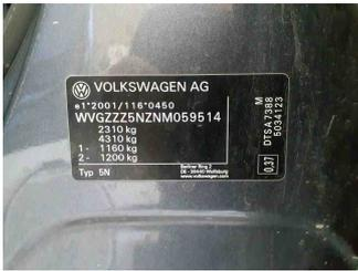
Fahrzeug - Typenschild/Fahrgestellnummer
