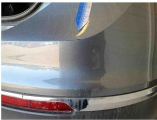
2 - Heckspoiler - Delle(n) und Kratzer - Ersetzen
