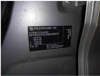
Fahrzeug - Typenschild/Fahrgestellnummer
