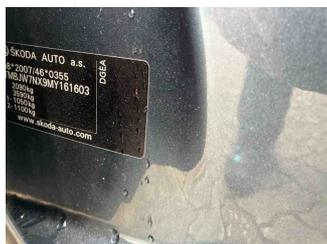
Fahrzeug - Typenschild/Fahrgestellnummer
