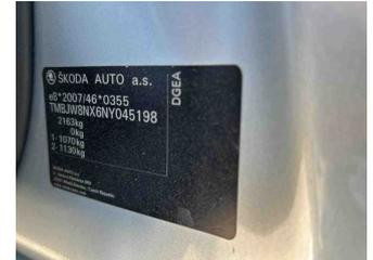
Fahrzeug - Typenschild/Fahrgestellnummer
