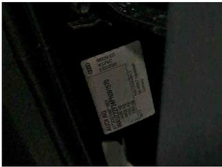
Fahrzeug - Typenschild/Fahrgestellnummer
