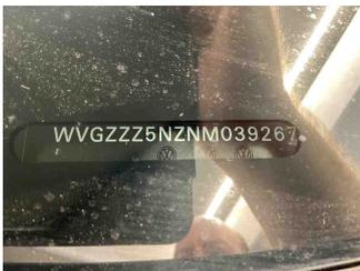
Fahrzeug - Typenschild/Fahrgestellnummer
