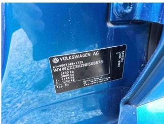
Fahrzeug - Typenschild/Fahrgestellnummer
