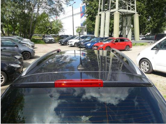
Bild 31: Karosserie / Dach Dellen und Kratzer
