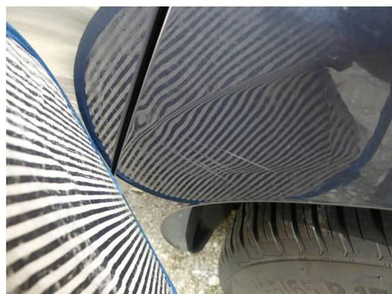
Bild 24: Karosserie / Seitenteil links deformiert und zerkratzt
