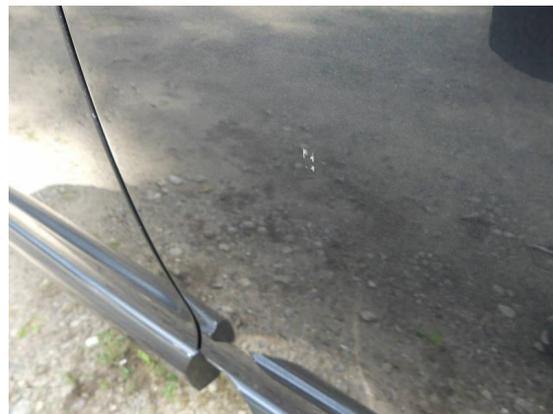
Bild 22: Karosserie / Tür hinten links Delle, leicht deformiert und zerkratzt
