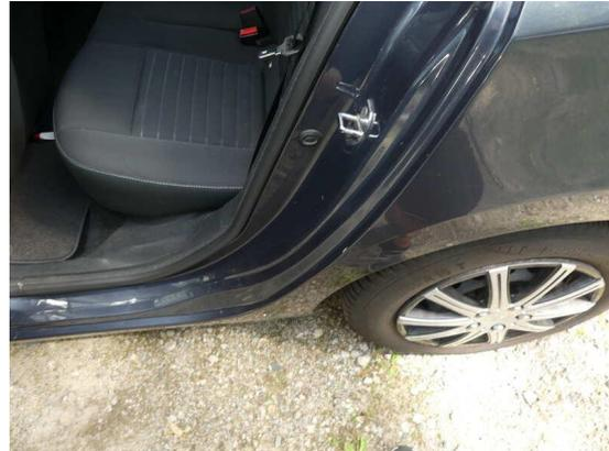
Bild 20: Karosserie / Einstieg hinten links zerkratzt
