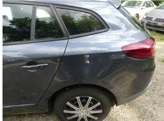
Bild 26: Karosserie / Seitenteil links deformiert und zerkratzt
