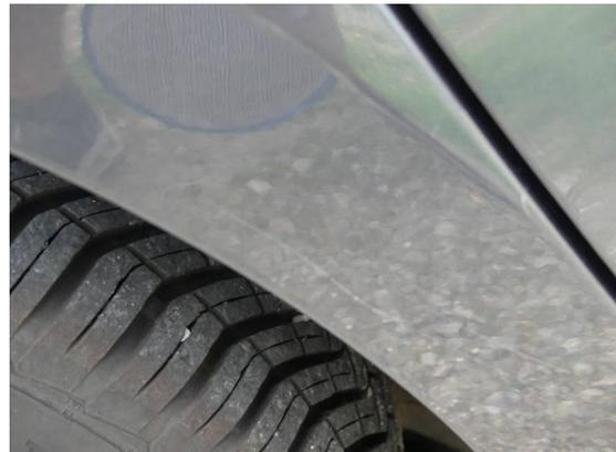
Bild 4: Karosserie / Seitenteil rechts zerkratzt
