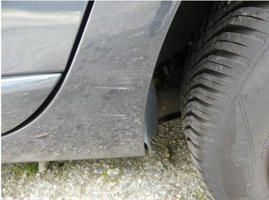
Bild 25: Karosserie / Seitenteil links deformiert und zerkratzt
