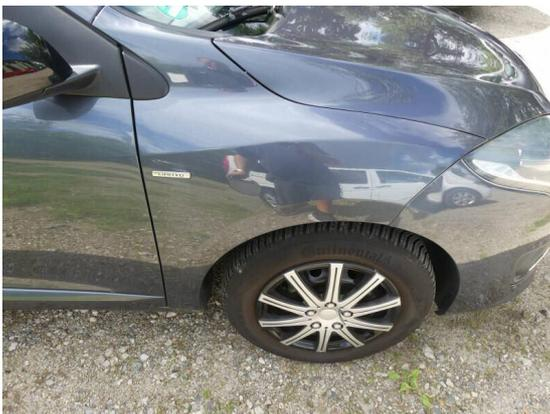
Bild 9: Karosserie / Kotflügel rechts Delle mit Kratzer
