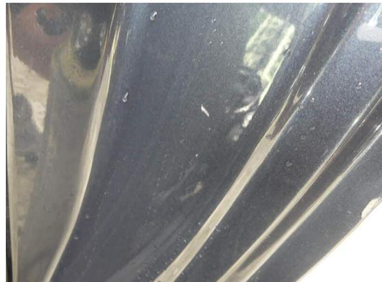
Bild 18: Karosserie / Einstieg hinten links zerkratzt
