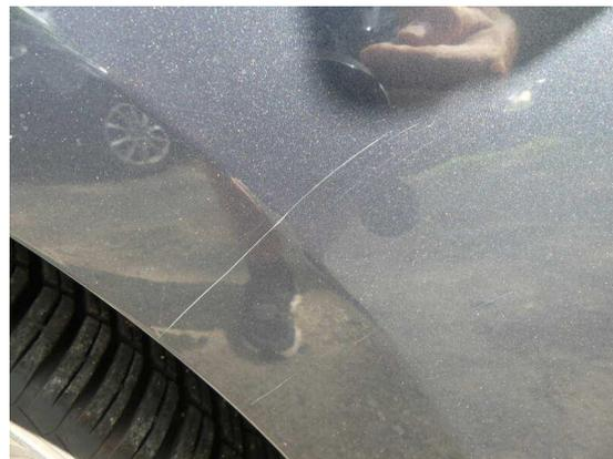
Bild 10: Karosserie / Kotflügel links Kratzer
