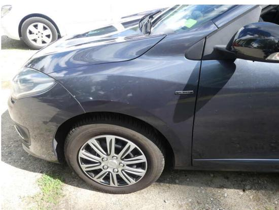
Bild 11: Karosserie / Kotflügel links Kratzer
