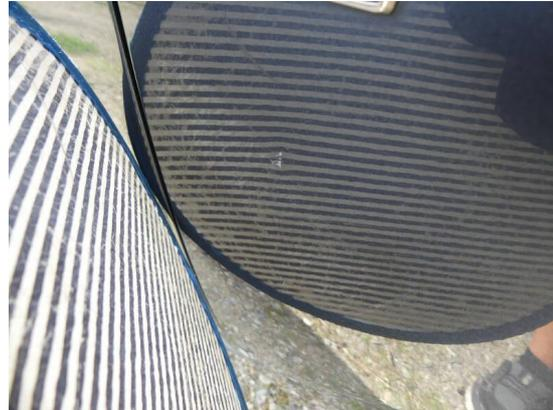
Bild 8: Karosserie / Kotflügel rechts Delle mit Kratzer
