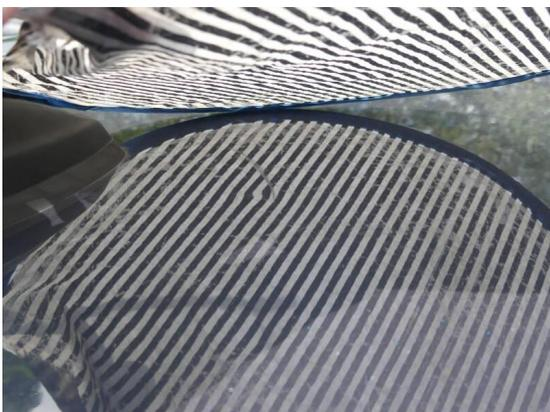
Bild 29: Karosserie / Dach Dellen und Kratzer
