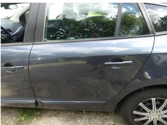
Bild 23: Karosserie / Tür hinten links Delle, leicht deformiert und zerkratzt
