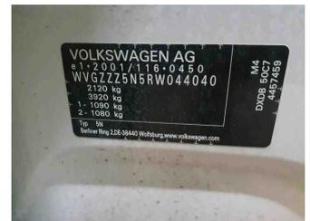
Fahrzeug - Typenschild/Fahrgestellnummer
