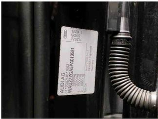
Fahrzeug - Typenschild/Fahrgestellnummer
