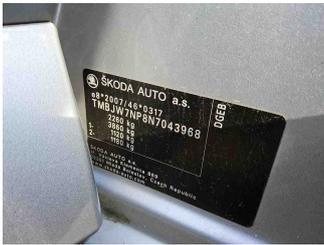
Fahrzeug - Typenschild/Fahrgestellnummer
