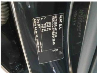
Fahrzeug - Typenschild/Fahrgestellnummer
