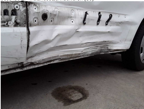
Beschädigung #8: Schweller links: Schweller (Unfallschaden) - beschädigt - erneuern
