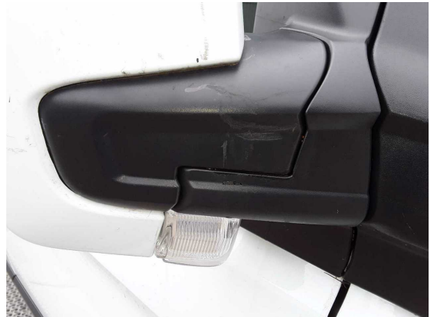
Beschädigung #2: Außenspiegel rechts: Abdeckkappe (Schwarz) - gebrochen / gerissen - erneuern
