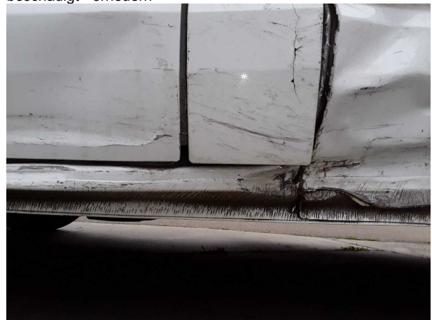
Beschädigung #8: Schweller links: Schweller (Unfallschaden... beschädigt - erneuern
