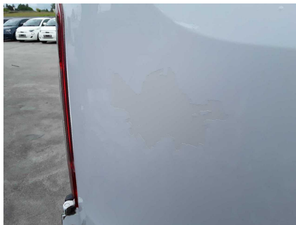
Beschädigung #9: Heckklappe/-tür: Hecktür links (Lackablösung) - Delle / Lackschaden - lackieren
