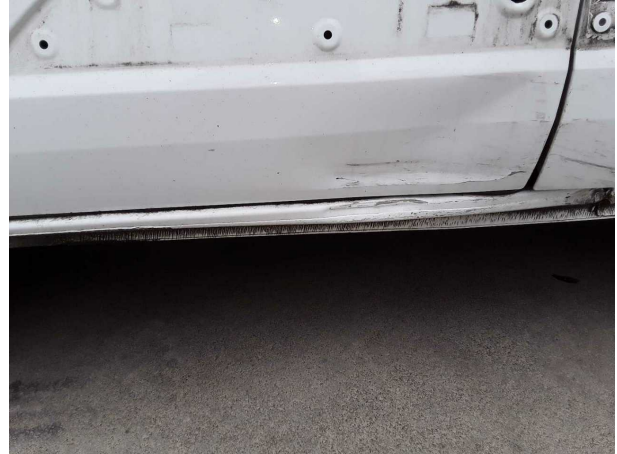
Beschädigung #8: Schweller links: Schweller (Unfallschaden... beschädigt - erneuern
