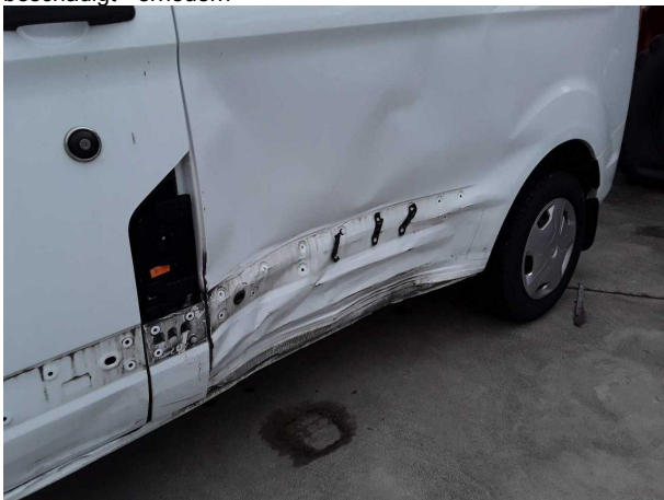
Beschädigung #5: Seitenwand links: Seitenwand (Unfallschaden... beschädigt - erneuern
