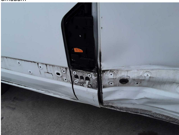
Beschädigung #4: Karosserie: B-Säule links (Unfallschaden) - beschädigt - erneuern
