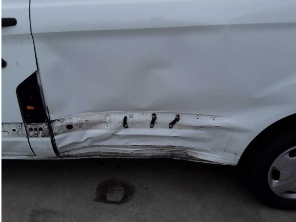
Beschädigung #5: Seitenwand links: Seitenwand (Unfallschaden... beschädigt - erneuern
