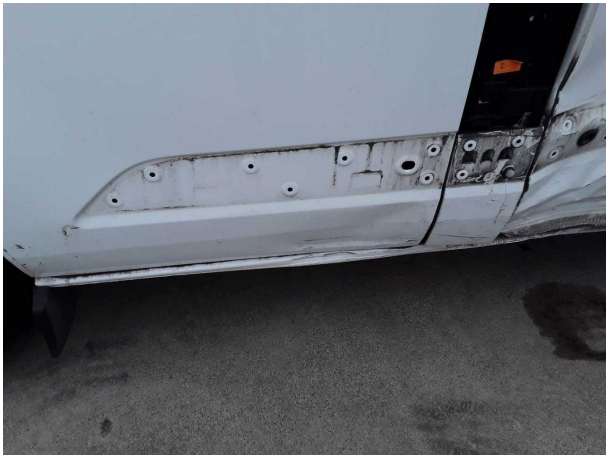
Beschädigung #3: Tür vorn links: Tür (Unfallfrei) - beschädigt - erneuern
