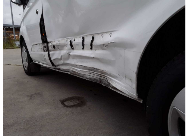
Beschädigung #5: Seitenwand links: Seitenwand (Unfallschaden) - beschädigt - erneuern
