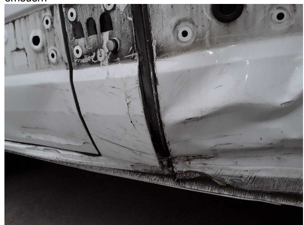
Beschädigung #4: Karosserie: B-Säule links (Unfallschaden) - beschädigt - erneuern
