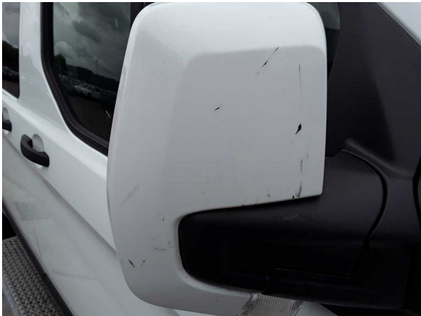
Beschädigung #1: Außenspiegel rechts: Abdeckkappe - Delle / Lackschaden - lackieren
