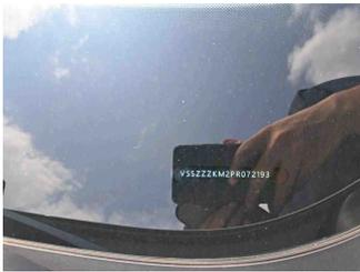
Fahrzeug - Typenschild/Fahrgestellnummer
