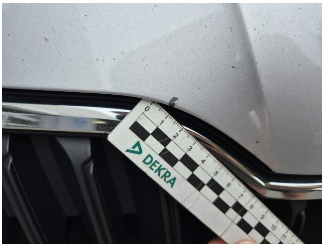
Fot. 32 Pokrywa komory silnika - Rysa/odprysk 1
