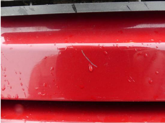
Bild 37: Karosserie / Heckklappe Kratzer
