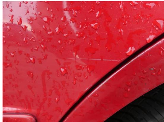
Bild 58: Karosserie / Tür hinten links Kratzer
