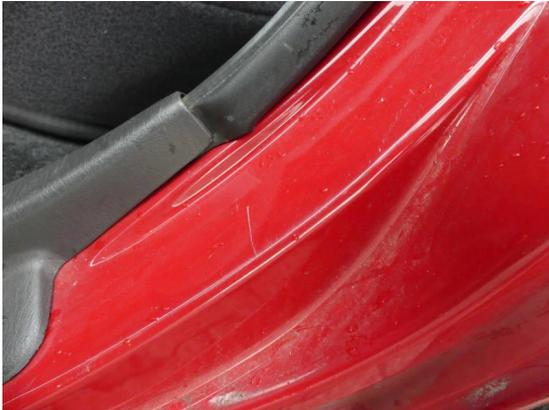
Bild 61: Karosserie / Einstieg hinten links Kratzer
