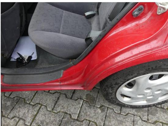
Bild 59: Karosserie / Einstieg hinten links Kratzer
