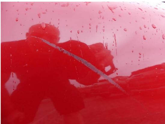
Bild 15: Karosserie / Kotflügel vorne rechts Kratzer
