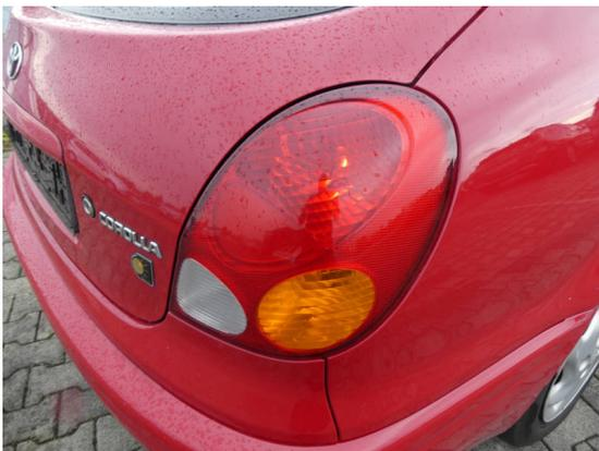
Bild 33: Karosserie / Rücklicht rechts gebrochen
