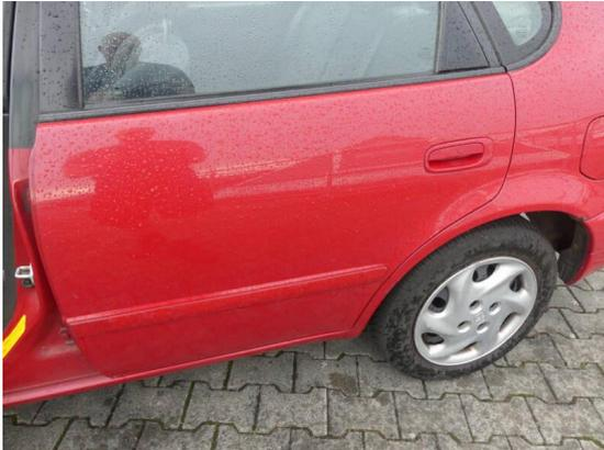
Bild 55: Karosserie / Tür hinten links Kratzer
