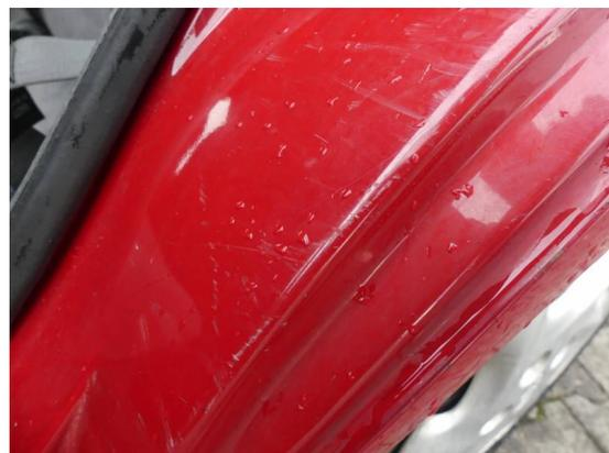
Bild 60: Karosserie / Einstieg hinten links Kratzer
