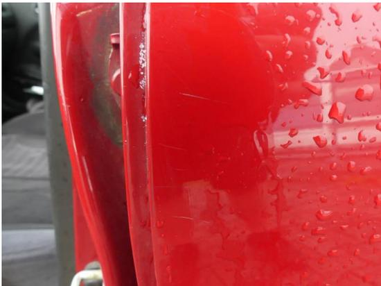
Bild 57: Karosserie / Tür hinten links Kratzer
