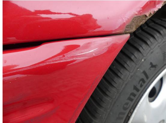
Bild 32: Karosserie / Stoßfänger hinten Kratzer
