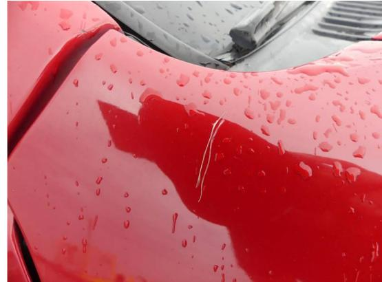
Bild 14: Karosserie / Kotflügel vorne rechts Kratzer
