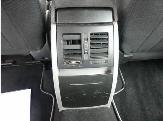
Bild 49: Innenraum / Lüftungsgitter Mittelkonsole hinten gebrochen
