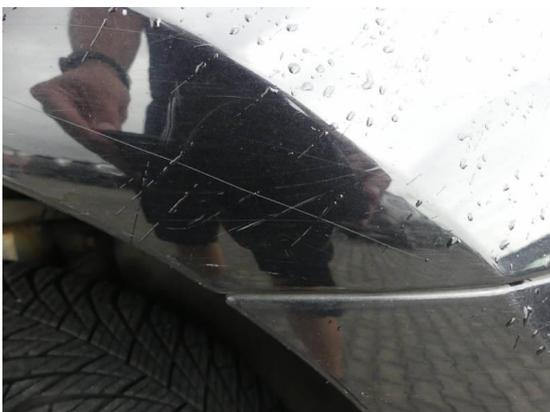
Bild 17: Karosserie / Kotflügel vorne rechts Kratzer
