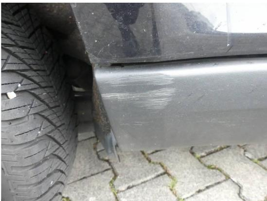
Bild 27: Karosserie / Schwellerbekleidung hinten rechts Kratzer
