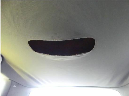
Bild 49: Innenraum / Dachhimmel hängt runter/abgelöst
