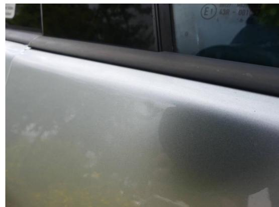
Bild 24: Karosserie / Tür vorne rechts Kratzer + Delle + Einpassung ungenau
