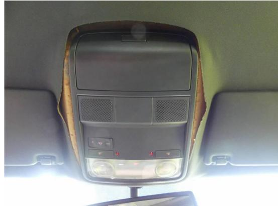
Bild 50: Innenraum / Dachhimmel hängt runter/abgelöst
