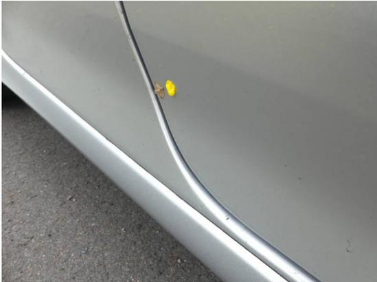
Bild 25: Karosserie / Tür vorne rechts Kratzer + Delle + Einpassung ungenau
