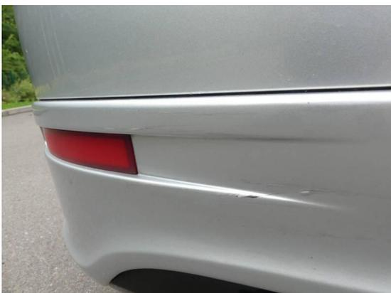
Bild 35: Karosserie / Stoßfänger hinten Kratzer
