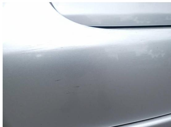
Bild 36: Karosserie / Stoßfänger hinten Kratzer
