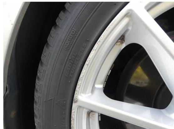
Bild 58: Reifen - Felge / Felge vorne rechts Kratzer
