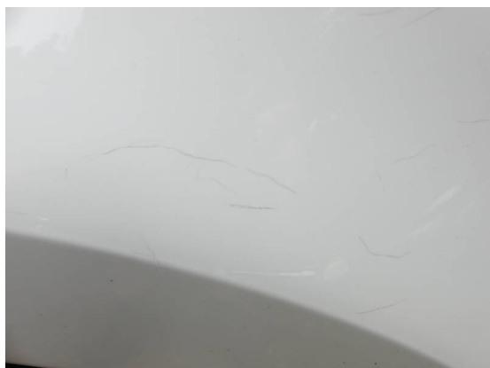
Bild 31: Karosserie / Kotflügel vorne links Kratzer
