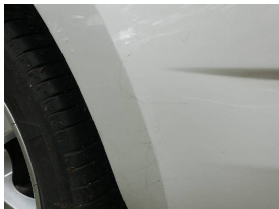
Bild 8: Karosserie / Stoßfänger hinten Kratzer
