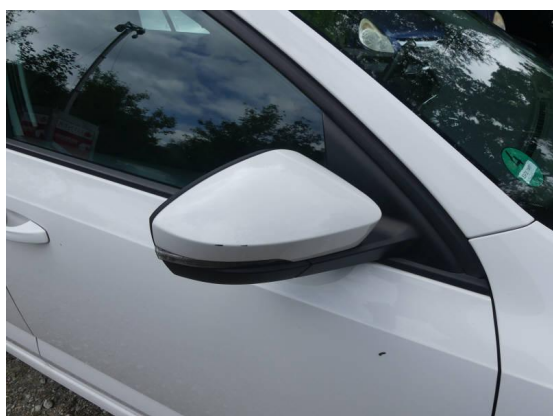
Bild 17: Karosserie / Spiegelkappen links und rechts Kratzer
