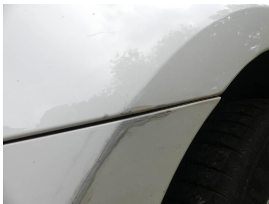
Bild 32: Karosserie / Kotflügel vorne links Kratzer
