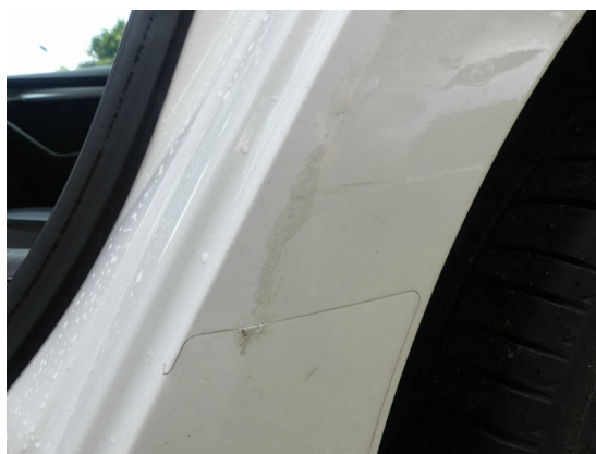
Bild 28: Karosserie / Fondsbereich links deformiert+Kratzer
