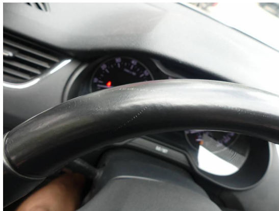
Bild 2: Innenraum / Lenkrad Kratzer
