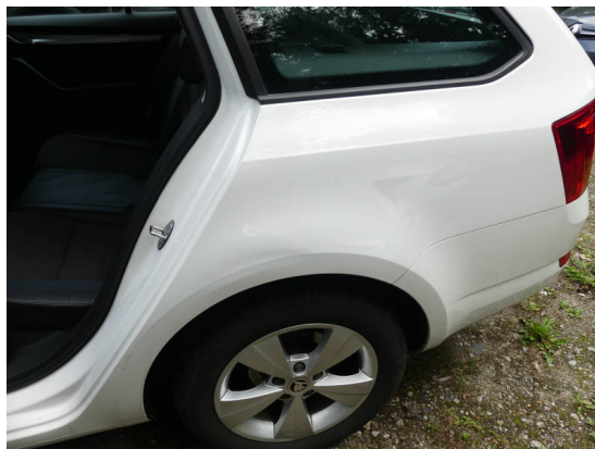
Bild 26: Karosserie / Fondsbereich links deformiert+Kratzer
