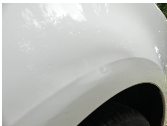
Bild 29: Karosserie / Fondsbereich links deformiert+Kratzer
