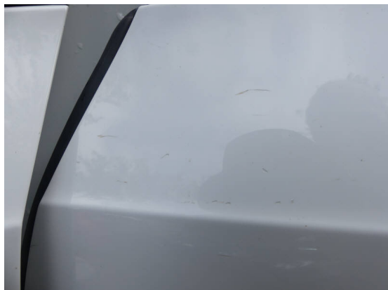
Bild 25: Karosserie / Tür hinten links Kratzer
