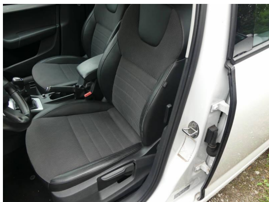
Bild 13: Innenraum / Fahrersitz Seitenwange abgenutzt
