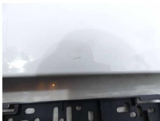
Bild 10: Karosserie / Heckklappe Kratzer
