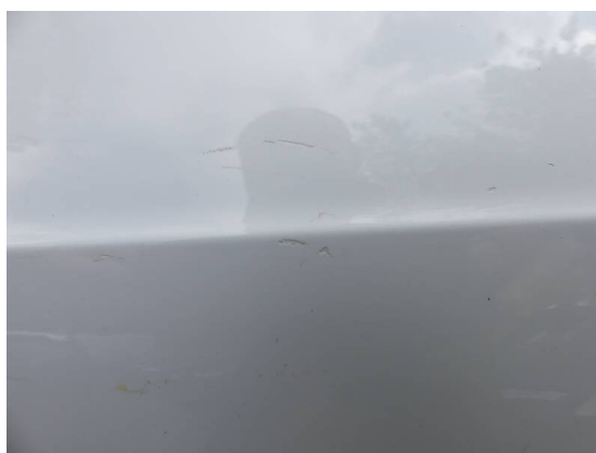
Bild 24: Karosserie / Tür hinten links Kratzer
