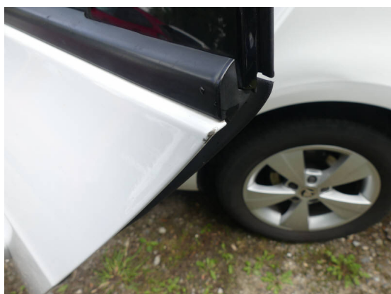
Bild 23: Karosserie / Tür hinten links Kratzer
