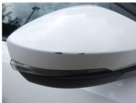
Bild 18: Karosserie / Spiegelkappen links und rechts Kratzer
