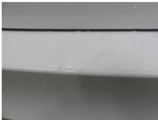
Bild 6: Karosserie / Stoßfänger hinten Kratzer
