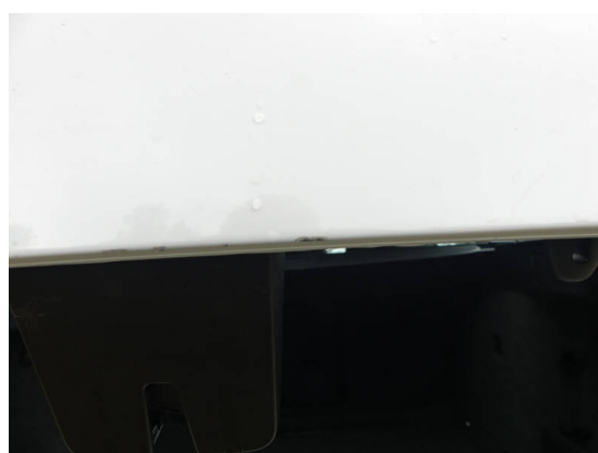
Bild 12: Karosserie / Heckklappe Kratzer
