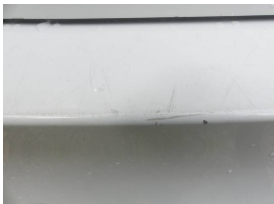
Bild 7: Karosserie / Stoßfänger hinten Kratzer
