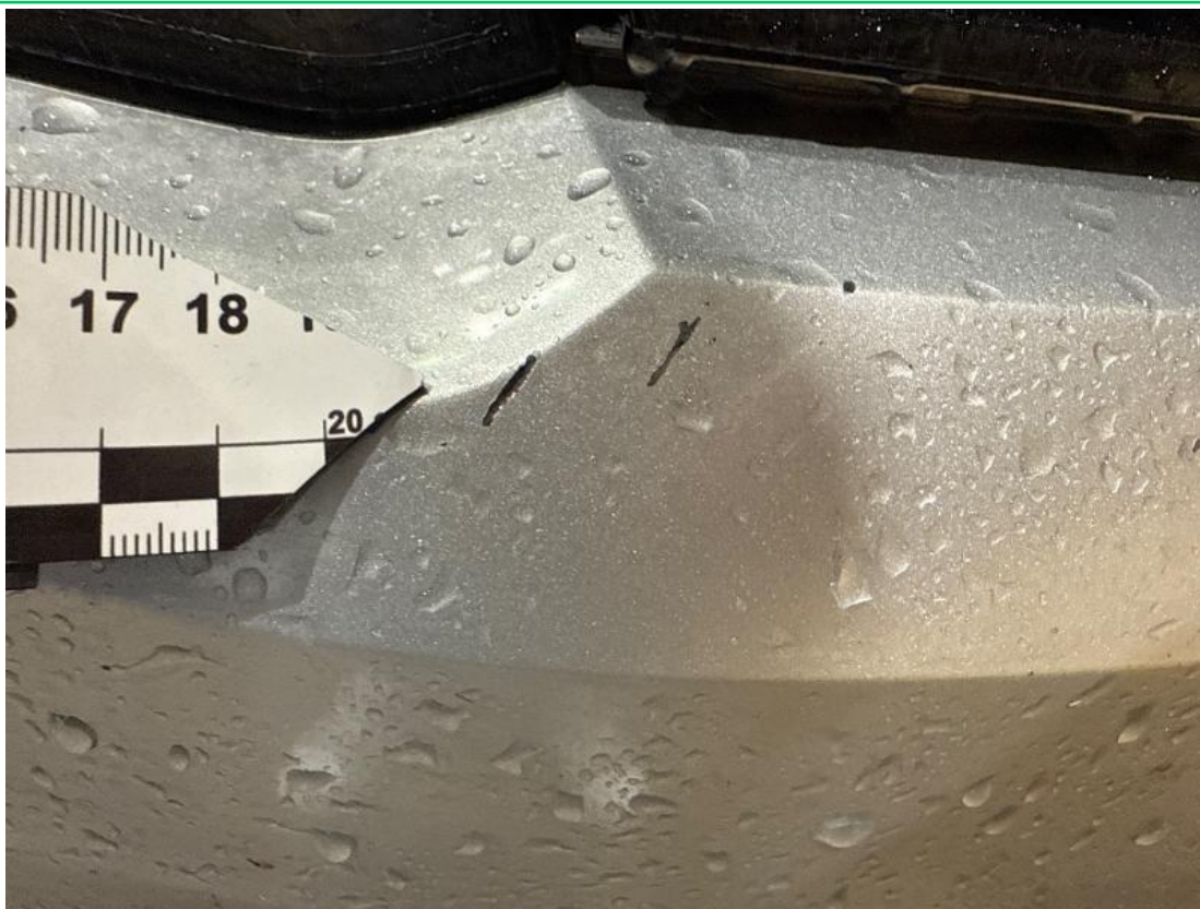
8. Stoßfänger vorne - Verkratzt
