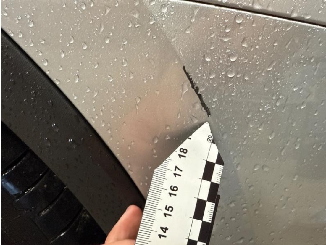
8. Stoßfänger vorne - Verkratzt
