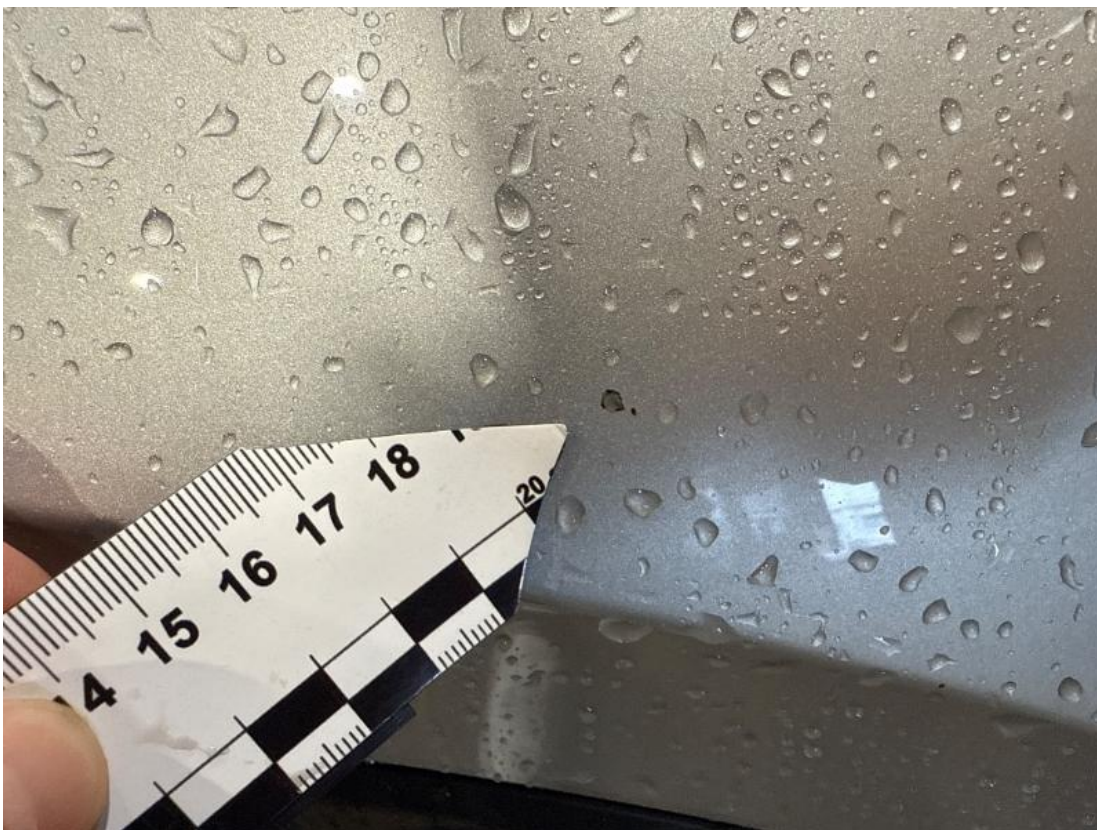
2. Kotflügel vorne rechts - Steinschlag
