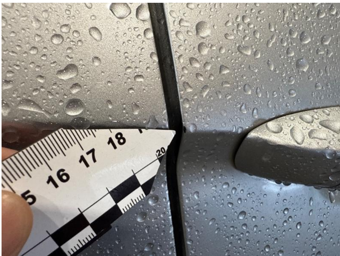
3. Tür vorne rechts - Kratzer
