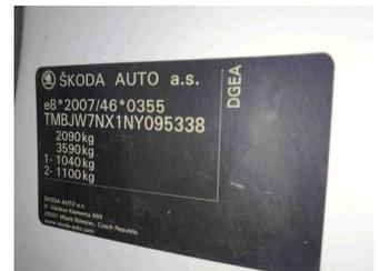
Fahrzeug - Typenschild/Fahrgestellnummer
