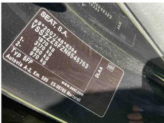
Fahrzeug - Typenschild/Fahrgestellnummer
