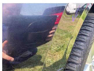
6 - Seitenwand hinten rechts - Kratzer - Polieren
