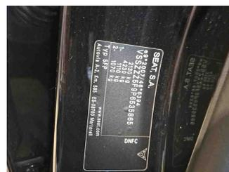
Fahrzeug - Typenschild/Fahrgestellnummer
