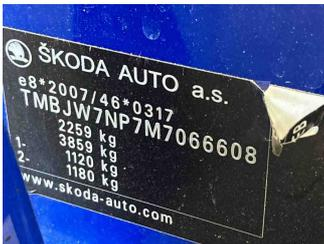
Fahrzeug - Typenschild/Fahrgestellnummer
