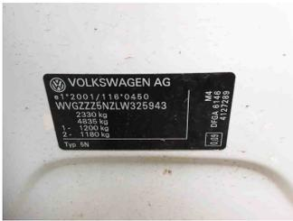
Fahrzeug - Typenschild/Fahrgestellnummer
