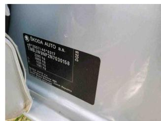
Fahrzeug - Typenschild/Fahrgestellnummer
