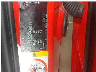
Fahrzeug - Typenschild/Fahrgestellnummer
