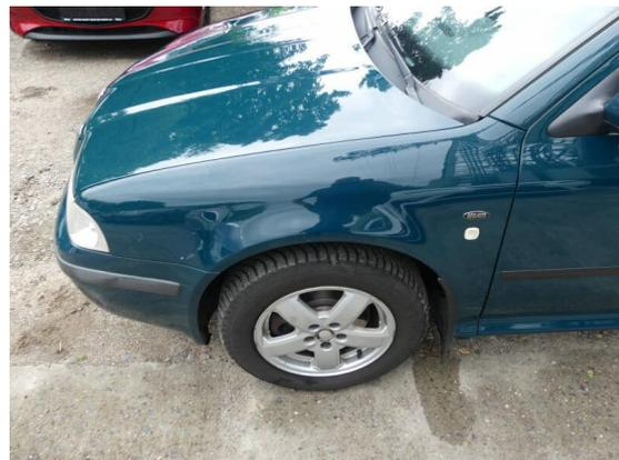
Bild 34: Karosserie / Kotflügel links Klarlackablösung und Steinschläge
