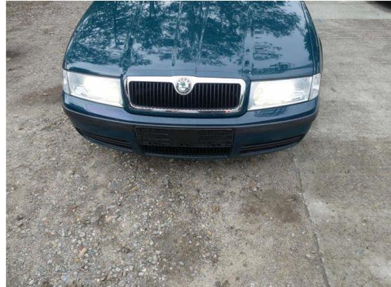
Bild 32: Karosserie / Stoßfänger vorn zerkratzt und Klarlackablösung
