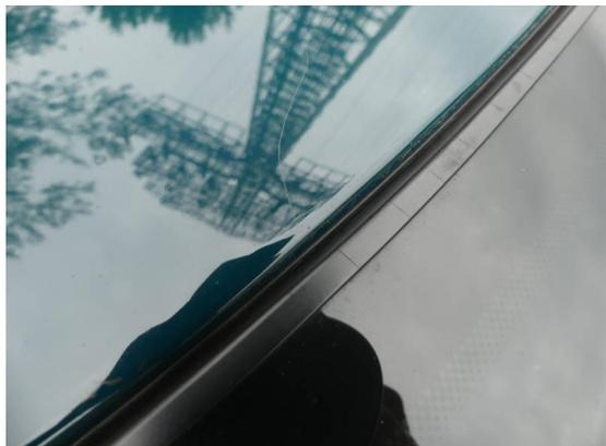
Bild 1: Karosserie / Dach zerkratzt und Vorschaden bricht auf
