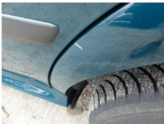
Bild 4: Karosserie / Seitenteil links leicht deformiert und zerkratzt
