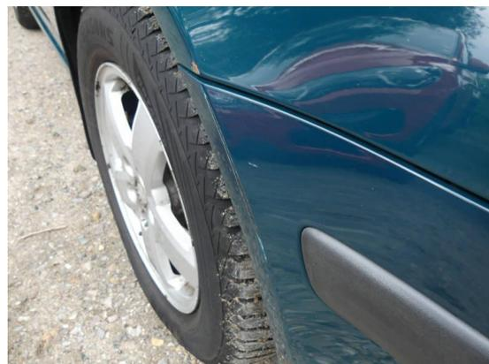
Bild 30: Karosserie / Stoßfänger vorn zerkratzt und Klarlackablösung
