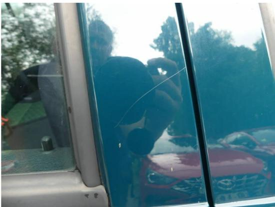
Bild 15: Karosserie / Tür hinten rechts zerkratzt
