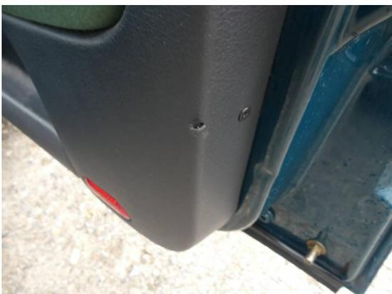
Bild 17: Innenraum / Türverkleidung vorne rechts Loch
