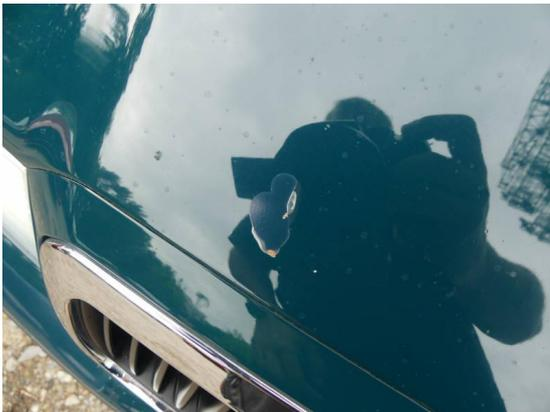
Bild 27: Karosserie / Motorhaube Steinschläge mit Korrosion und Klarlackablösung
