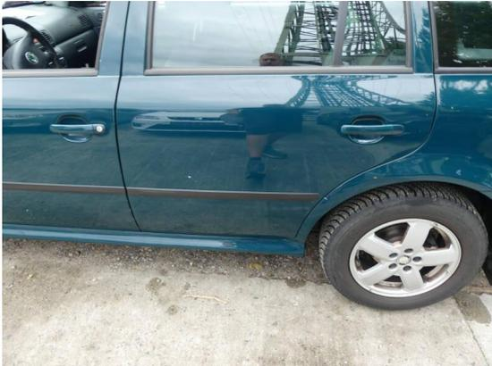
Bild 43: Karosserie / Tür hinten links Steinschläge, zerkratzt und Klarlackablösung
