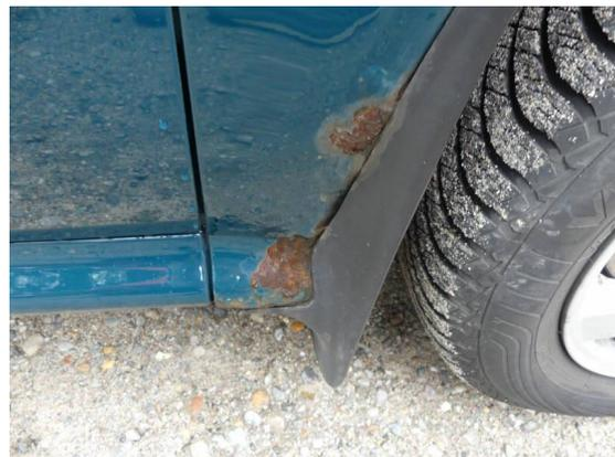
Bild 22: Karosserie / Kotflügel rechts Korrosion
