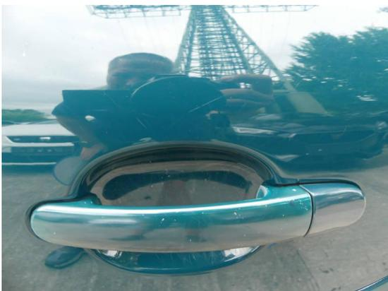
Bild 41: Karosserie / Tür hinten links Steinschläge, zerkratzt und Klarlackablösung
