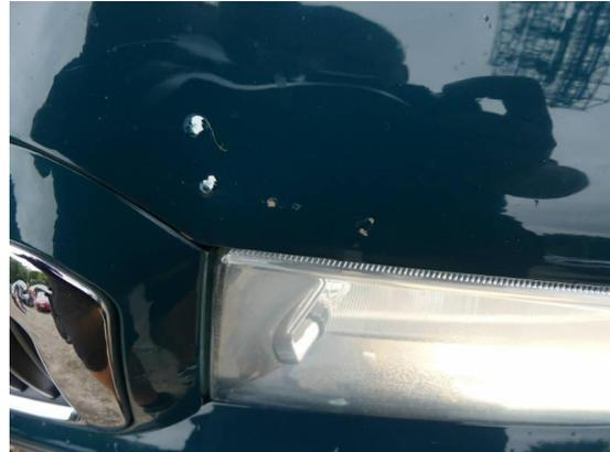
Bild 26: Karosserie / Motorhaube Steinschläge mit Korrosion und Klarlackablösung
