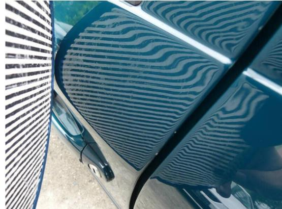
Bild 38: Karosserie / Tür vorne links Delle, Steinschläge und Klarlackablösung
