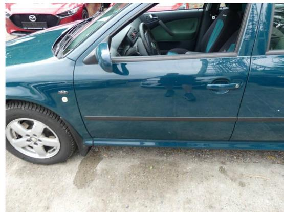
Bild 40: Karosserie / Tür vorne links Delle, Steinschläge und Klarlackablösung
