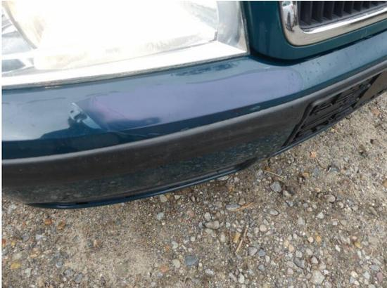
Bild 31: Karosserie / Stoßfänger vorn zerkratzt und Klarlackablösung
