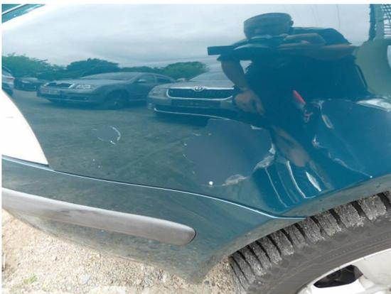
Bild 33: Karosserie / Kotflügel links Klarlackablösung und Steinschläge
