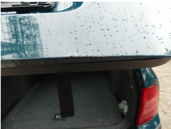
Bild 9: Karosserie / Heckklappe Korrosionsansatz
