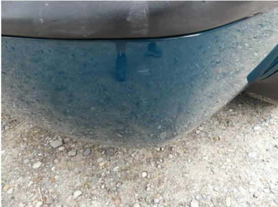
Bild 7: Karosserie / Stoßfänger hinten Kratzer
