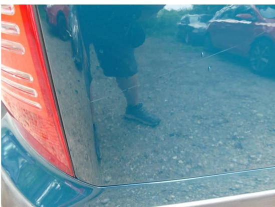
Bild 11: Karosserie / Seitenteil rechts zerkratzt
