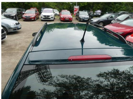
Bild 3: Karosserie / Dach zerkratzt und Vorschaden bricht auf
