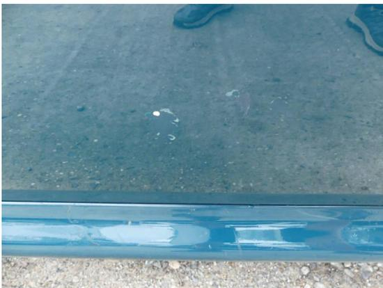
Bild 39: Karosserie / Tür vorne links Delle, Steinschläge und Klarlackablösung
