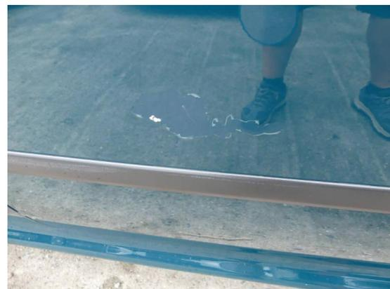
Bild 42: Karosserie / Tür hinten links Steinschläge, zerkratzt und Klarlackablösung
