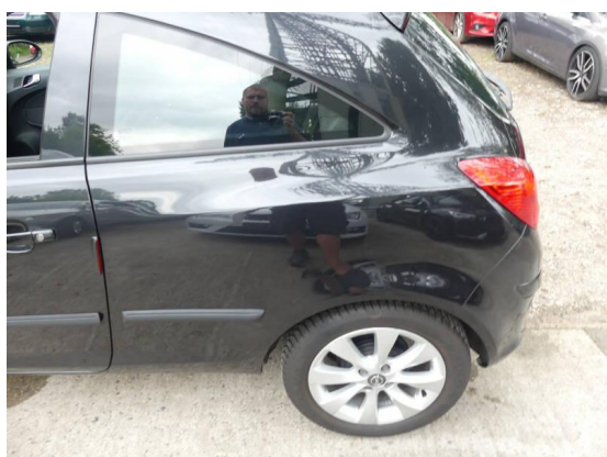
Bild 21: Karosserie / Seitenteil links zerkratzt
