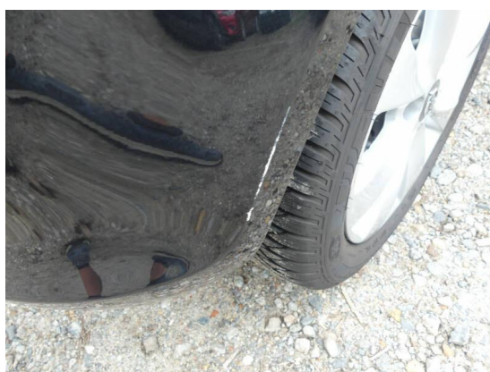
Bild 22: Karosserie / Stoßfänger hinten zerkratzt
