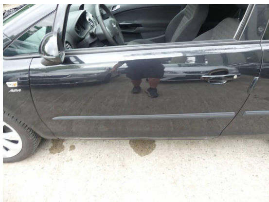
Bild 19: Karosserie / Tür links zerkratzt
