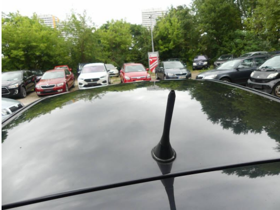
Bild 25: Technik / Antennenstab abgebrochen
