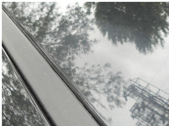
Bild 7: Karosserie / Dach Lackverätzung und zerkratzt
