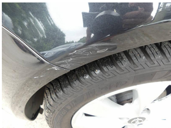
Bild 13: Karosserie / Kotflügel links leicht deformiert und zerkratzt
