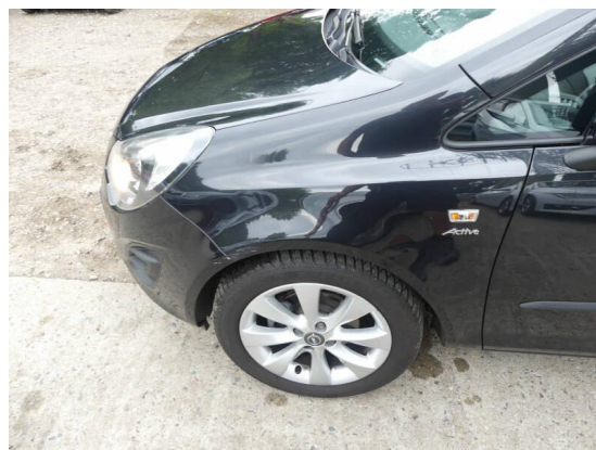
Bild 14: Karosserie / Kotflügel links leicht deformiert und zerkratzt
