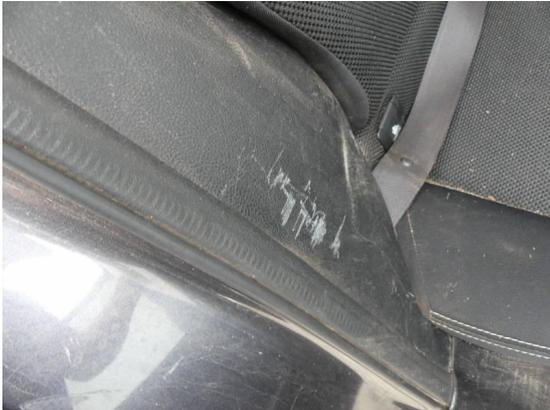
Bild 25: Innenraum / Verkleidung neben Rücksitzlehne rechts und links Kratzer
