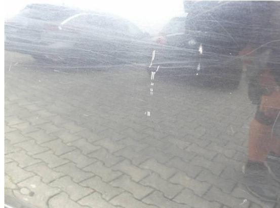
Bild 20: Karosserie / Tür vorne links leicht deformiert und zerkratzt
