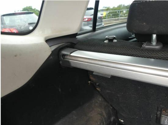
Bild 73: Innenraum / Kofferraumrollo defekt ( Abdeckung fehlt im Kasten )
