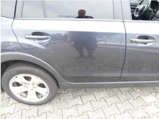
Bild 49: Karosserie / Tür hinten rechts zerkratzt
