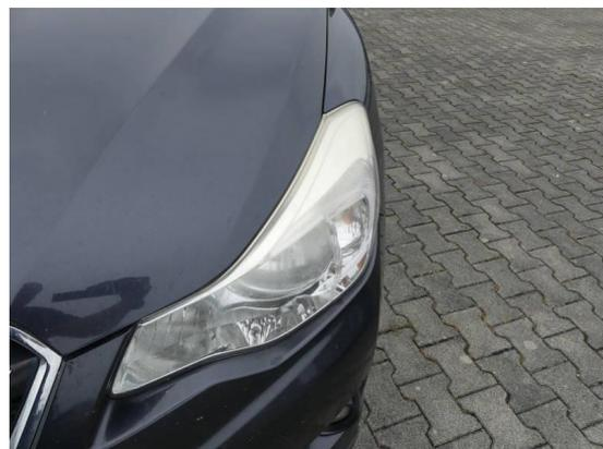
Bild 66: Technik / Scheinwerfer rechts und links matt/blind
