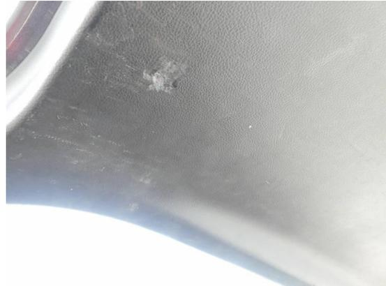
Bild 74: Innenraum / Heckklappenverkleidung Kratzer
