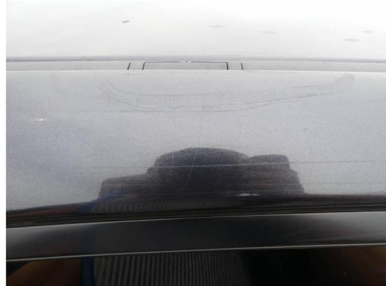
Bild 50: Karosserie / Dachholm rechts zerkratzt
