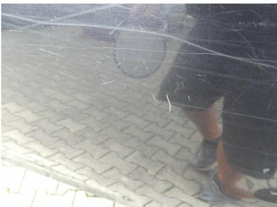
Bild 29: Karosserie / Tür hinten links deformiert und zerkratzt
