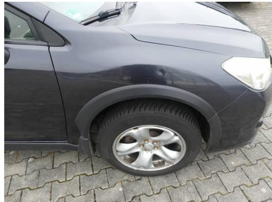
Bild 64: Karosserie / Kotflügel rechts deformiert und zerkratzt
