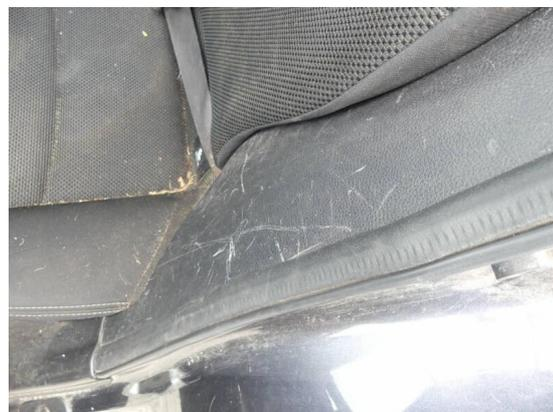
Bild 24: Innenraum / Verkleidung neben Rücksitzlehne rechts und links Kratzer
