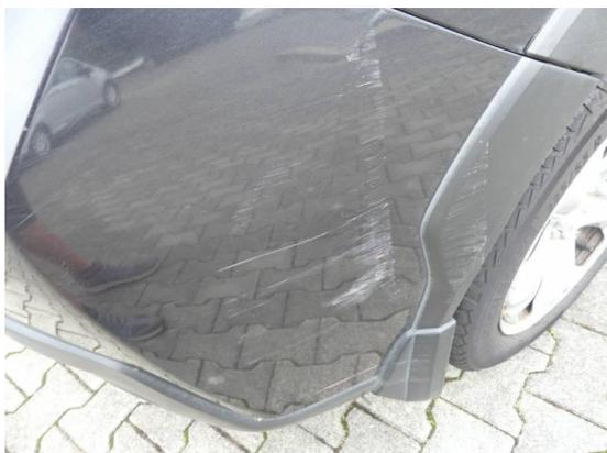
Bild 35: Karosserie / Stoßfänger hinten zerkratzt
