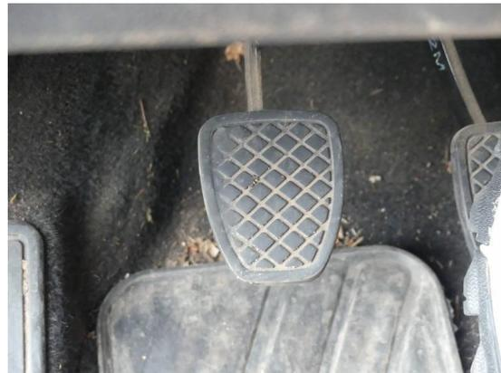
Bild 70: Technik / Kupplung verschlissen
