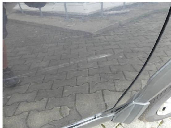
Bild 60: Karosserie / Tür vorne rechts Delle und zerkratzt
