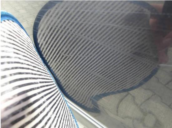
Bild 19: Karosserie / Tür vorne links leicht deformiert und zerkratzt
