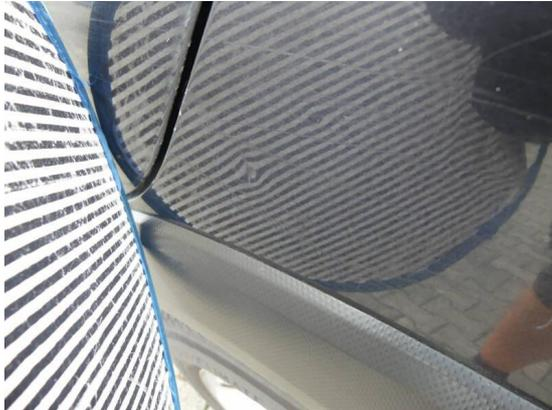
Bild 31: Karosserie / Seitenteil links Dellen und zerkratzt
