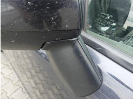
Bild 67: Karosserie / Spiegelgehäuse rechts gebrochen
