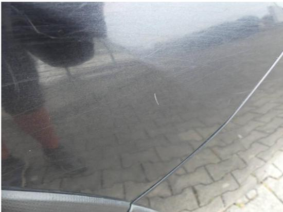
Bild 63: Karosserie / Kotflügel rechts deformiert und zerkratzt
