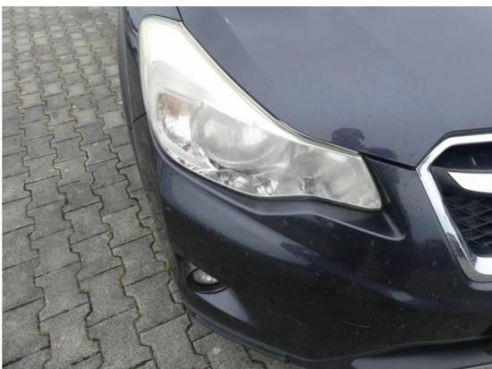
Bild 65: Technik / Scheinwerfer rechts und links matt/blind
