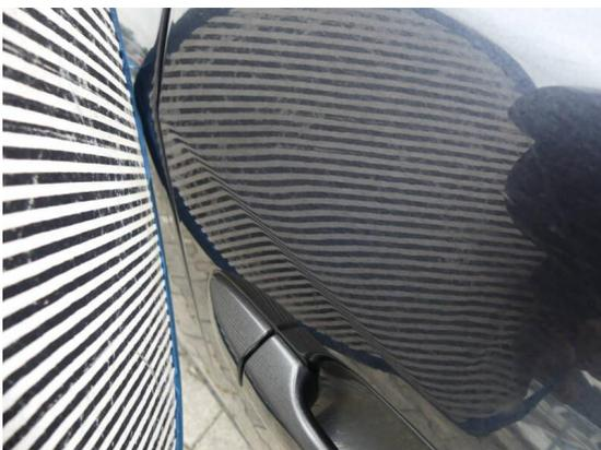
Bild 59: Karosserie / Tür vorne rechts Delle und zerkratzt
