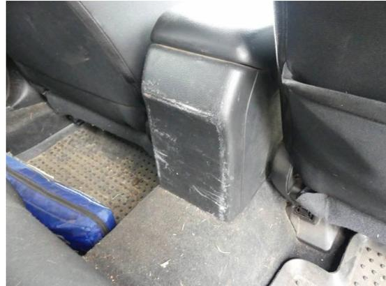
Bild 44: Innenraum / Verkleidung Mittelkonsole hinten Kratzer
