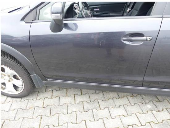
Bild 21: Karosserie / Tür vorne links leicht deformiert und zerkratzt
