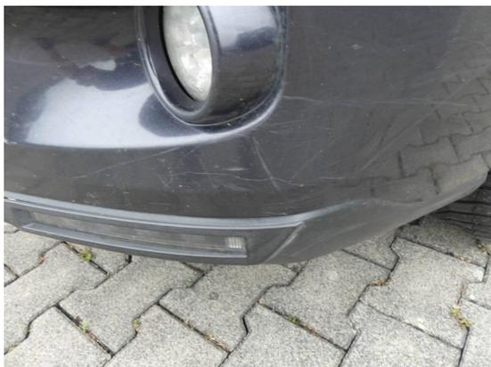
Bild 3: Karosserie / Stoßfänger vorn zerkratzt
