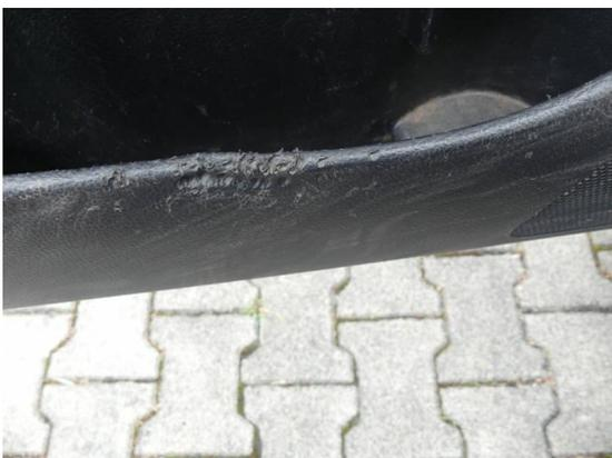
Bild 17: Innenraum / Türverkleidung vorne links Bisspuren
