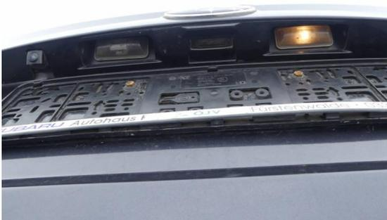
Bild 23: Technik / Kennzeichenbeleuchtung links ohne Funktion
