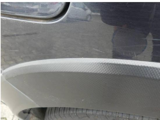
Bild 41: Karosserie / Seitenteil rechts leicht deformiert und zerkratzt
