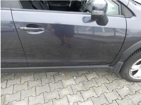
Bild 61: Karosserie / Tür vorne rechts Delle und zerkratzt
