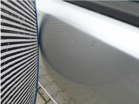
Bild 13: Karosserie / Tür hinten links Delle und zerkratzt
