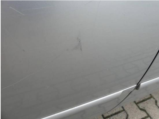
Bild 31: Karosserie / Tür hinten rechts zerkratzt
