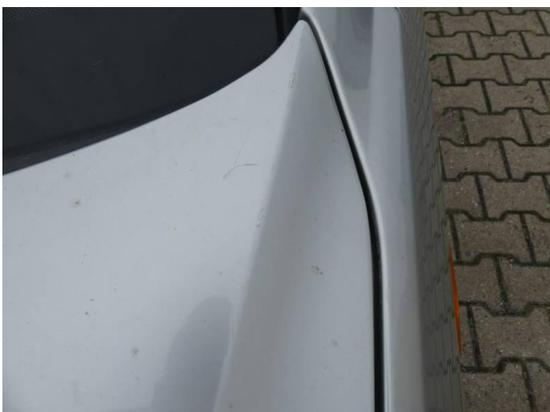
Bild 47: Karosserie / Motorhaube zerkratzt
