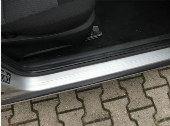
Bild 37: Karosserie / Einstieg vorne rechts zerkratzt
