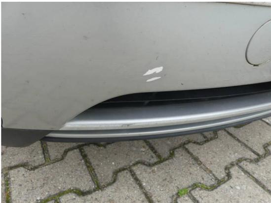
Bild 51: Karosserie / Stoßfänger vorn zerkratzt
