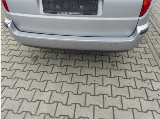
Bild 19: Karosserie / Stoßfänger hinten gebrochen
