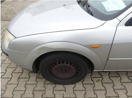
Bild 55: Karosserie / Kotflügel links deformiert und zerkratzt
