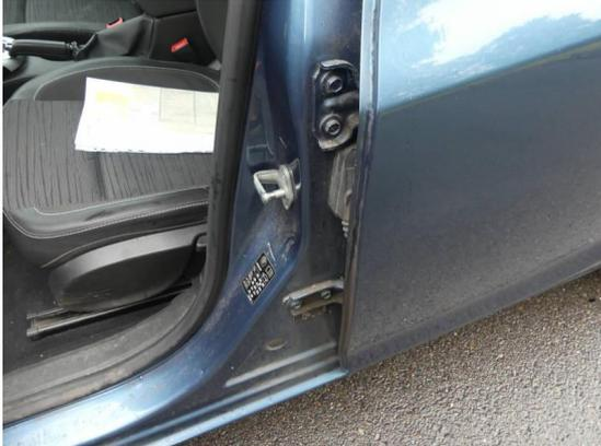
Bild 61: Karosserie / B-Säule links zerkratzt
