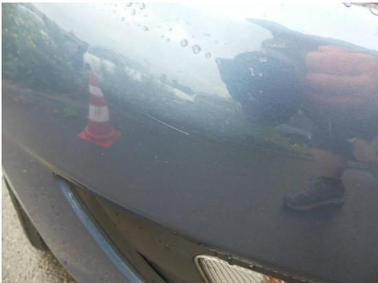
Bild 51: Karosserie / Stoßfänger vorn zerkratzt
