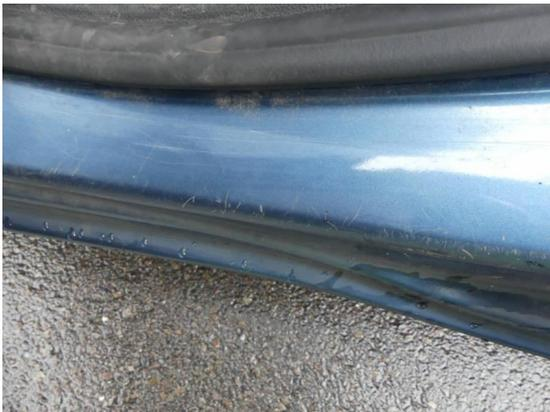
Bild 9: Karosserie / Einstieg hinten links zerkratzt
