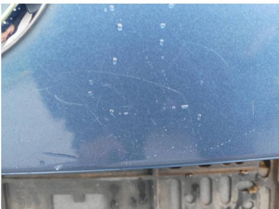
Bild 23: Karosserie / Heckklappe Dellen und zerkratzt
