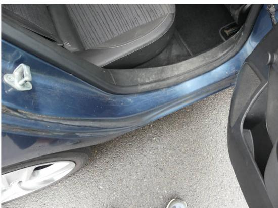
Bild 29: Karosserie / Einstieg hinten rechts zerkratzt
