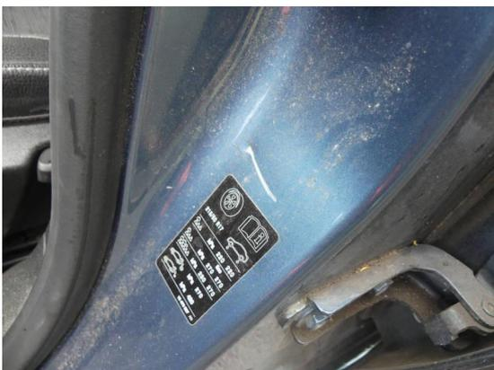
Bild 59: Karosserie / B-Säule links zerkratzt
