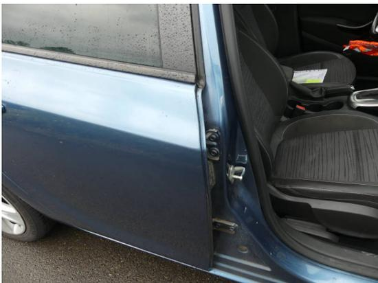
Bild 33: Karosserie / B-Säule rechts Delle und zerkratzt
