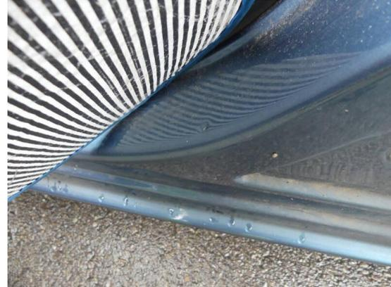
Bild 62: Karosserie / Einstieg vorne links Delle und zerkratzt
