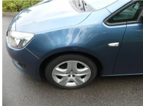
Bild 56: Karosserie / Kotflügel links zerkratzt und Steinschläge
