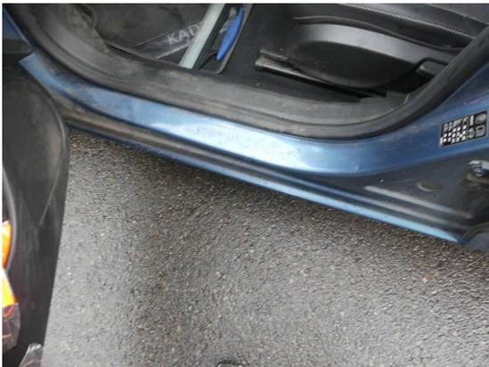
Bild 63: Karosserie / Einstieg vorne links Delle und zerkratzt
