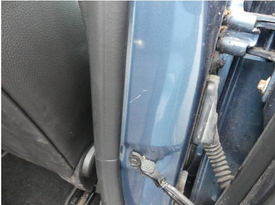
Bild 31: Karosserie / B-Säule rechts Delle und zerkratzt
