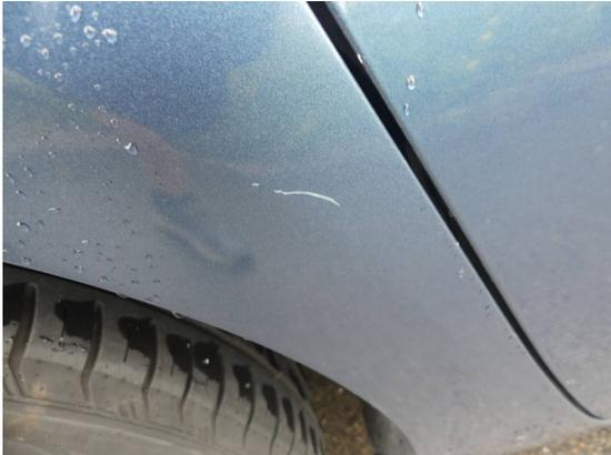
Bild 25: Karosserie / Seitenteil rechts zerkratzt
