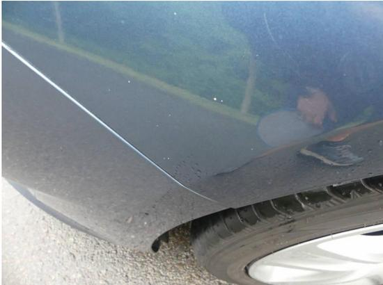
Bild 55: Karosserie / Kotflügel links zerkratzt und Steinschläge
