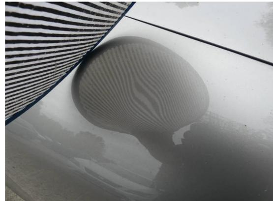
Bild 4: Karosserie / Seitenteil links deformiert
