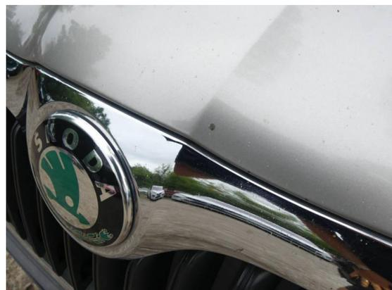
Bild 18: Karosserie / Motorhaube Steinschläge
