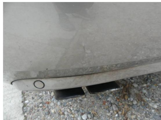
Bild 6: Karosserie / Stoßfänger hinten leicht deformiert und zerkratzt
