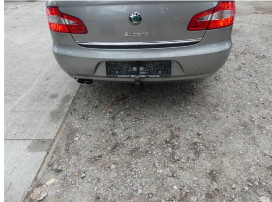
Bild 8: Karosserie / Stoßfänger hinten leicht deformiert und zerkratzt
