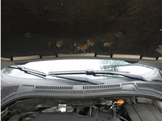
Bild 1: Technik / Dämmmatte Motorhaube eingerissen
