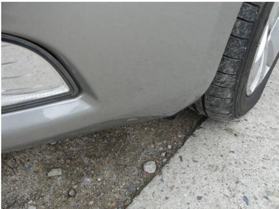
Bild 21: Karosserie / Stoßfänger vorn zerkratzt
