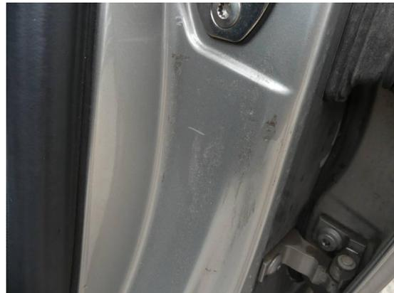
Bild 28: Karosserie / B-Säule links Kratzer
