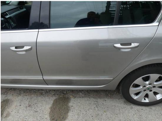
Bild 3: Karosserie / Tür hinten links Kratzer
