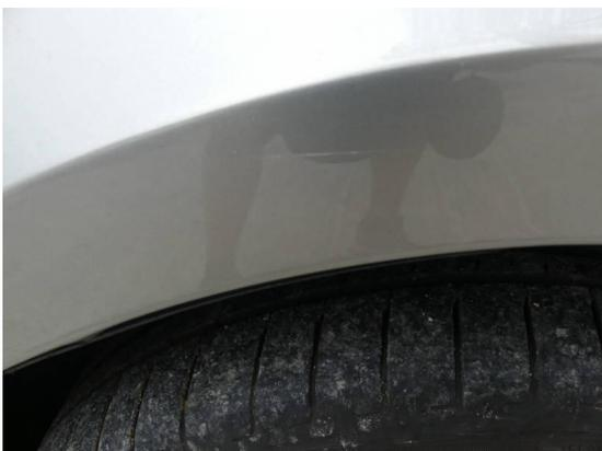
Bild 23: Karosserie / Kotflügel links zerkratzt
