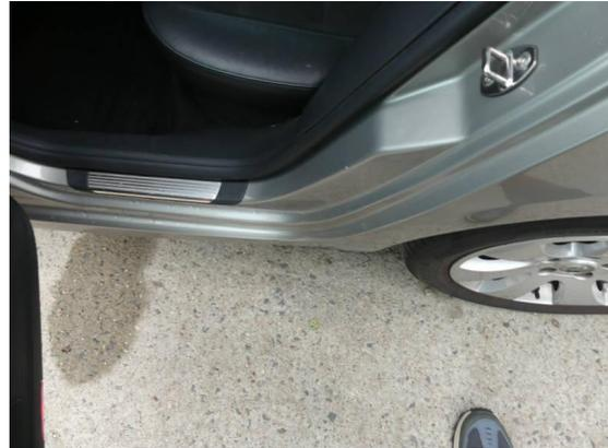
Bild 32: Karosserie / Einstieg hinten links Kratzer
