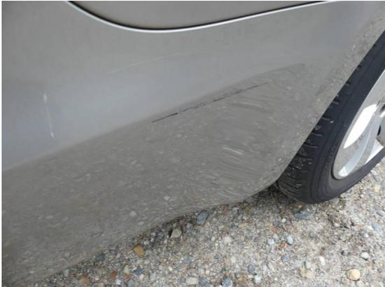
Bild 7: Karosserie / Stoßfänger hinten leicht deformiert und zerkratzt
