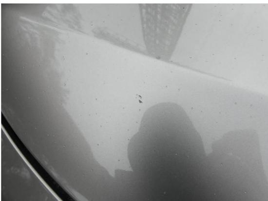
Bild 17: Karosserie / Motorhaube Steinschläge
