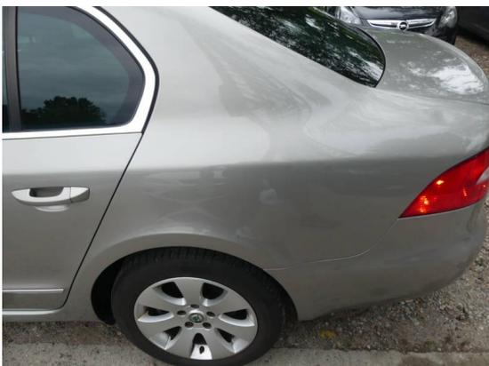
Bild 5: Karosserie / Seitenteil links deformiert
