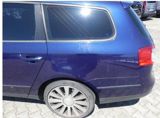
Bild 28: Karosserie / Seitenteil links zerkratzt
