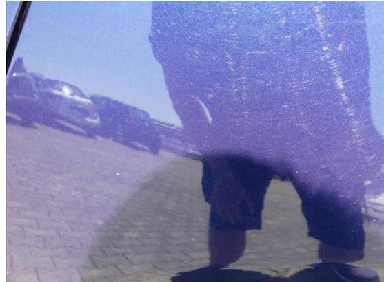
Bild 26: Karosserie / Seitenteil links zerkratzt
