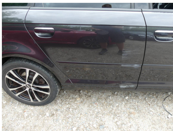
Bild 9: Karosserie / Tür hinten rechts deformiert und zerkratzt
