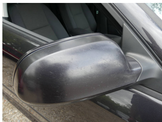
Bild 12: Karosserie / Spiegelkappe rechts matt lackiert
