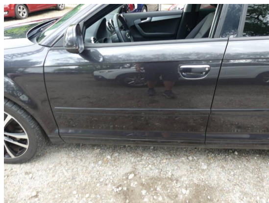
Bild 32: Karosserie / Tür vorne links Kratzer
