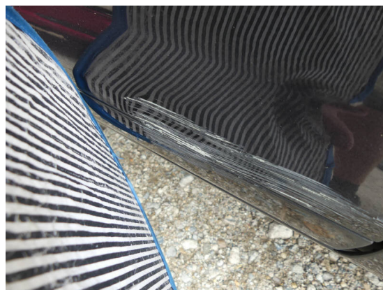
Bild 8: Karosserie / Tür hinten rechts deformiert und zerkratzt
