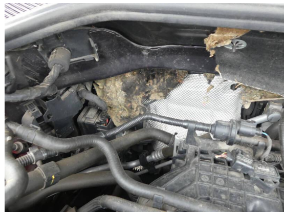
Bild 16: Technik / Dämmmatte Spritzwand zerrissen
