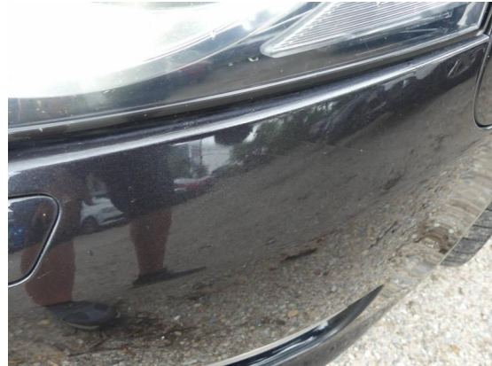
Bild 20: Karosserie / Stoßfänger vorn Klarlack löst sich ab und gestaucht
