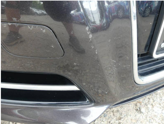
Bild 19: Karosserie / Stoßfänger vorn Klarlack löst sich ab und gestaucht
