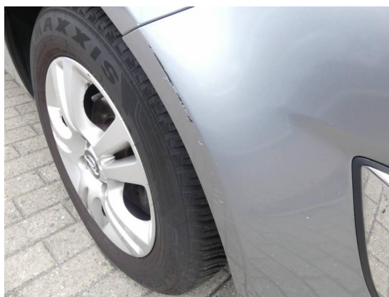
Bild 22: Karosserie / Stoßfänger vorn zerkratzt und gebrochen
