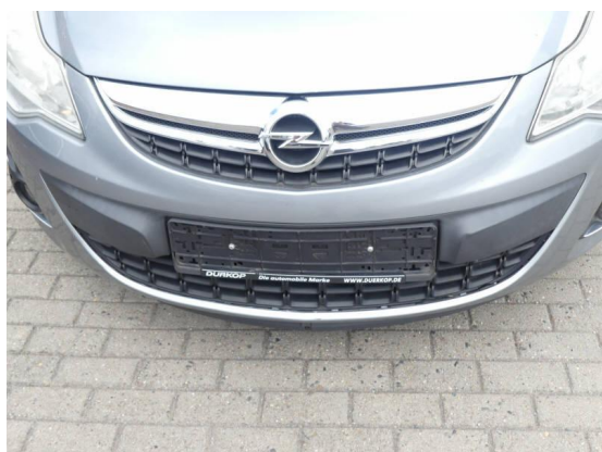
Bild 23: Karosserie / Stoßfänger vorn zerkratzt und gebrochen
