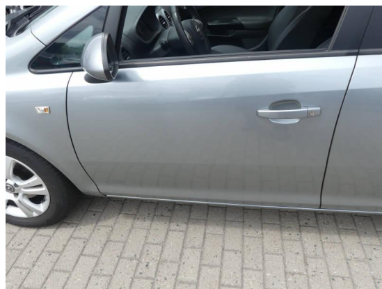
Bild 32: Karosserie / Tür vorne links Delle und zerkratzt
