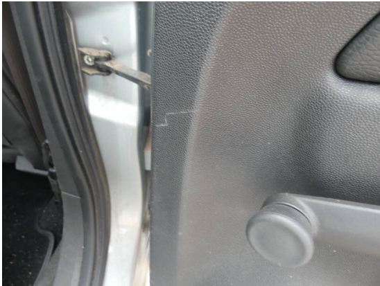
Bild 13: Innenraum / Türverkleidung hinten rechts Kratzer
