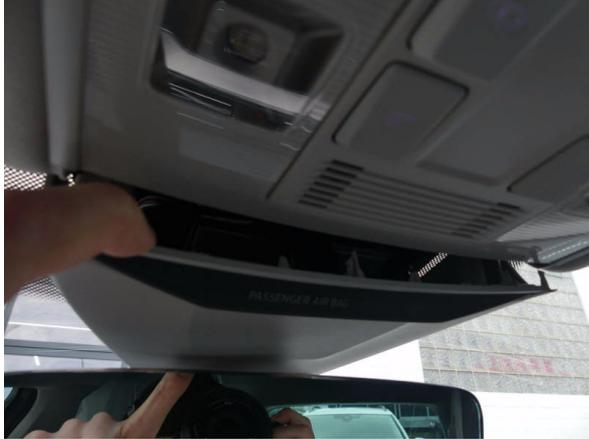
Bild 25: Verkleidung Kamerasystem gebrochen / lose - erneuern
