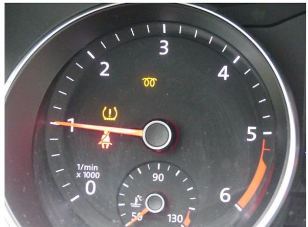
Bild 16: Fehlerspeicher / Kontrollleuchten
