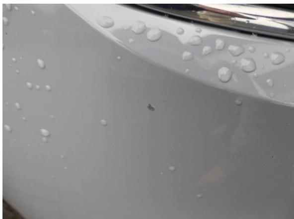
Bild 23: Stossfänger vorn Delle/Kratzer - Smart Repair
