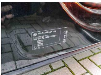
Fahrzeug - Typenschild/Fahrgestellnummer
