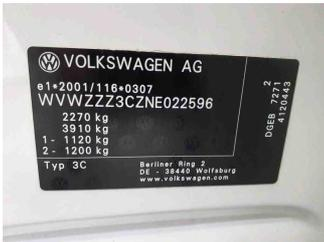
Fahrzeug - Typenschild/Fahrgestellnummer
