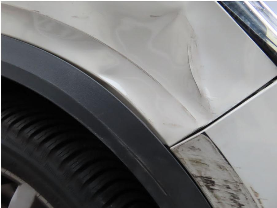
Kotflügel vorne rechts beschädigt
