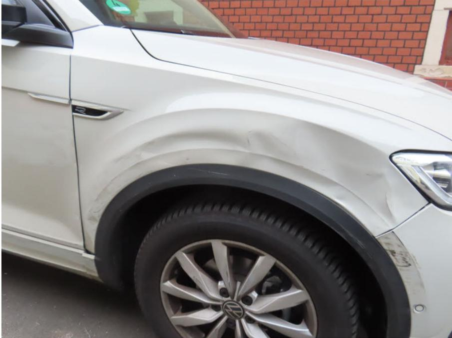
Kotflügel vorne rechts beschädigt
