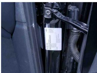
Fahrzeug - Typenschild/Fahrgestellnummer
