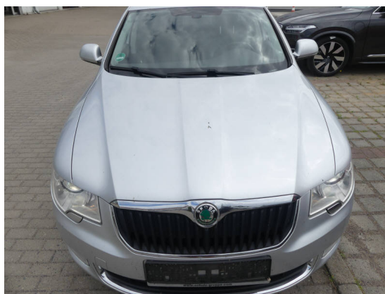
Bild 10: Karosserie / Motorhaube Steinschläge mit Korrosion
