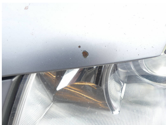
Bild 9: Karosserie / Motorhaube Steinschläge mit Korrosion
