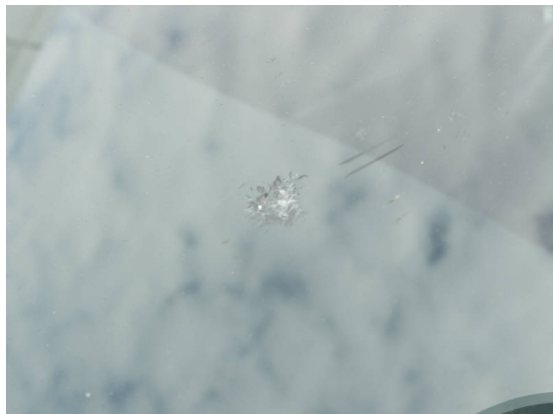
Bild 1: Karosserie / Frontscheibe Steinschlag
