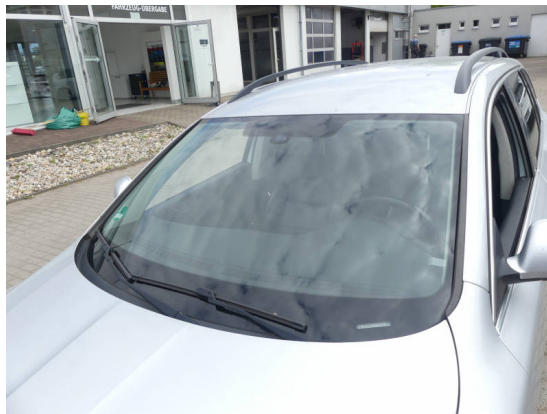
Bild 2: Karosserie / Frontscheibe Steinschlag
