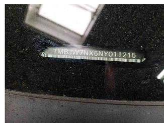
Fahrzeug - Typenschild/Fahrgestellnummer
