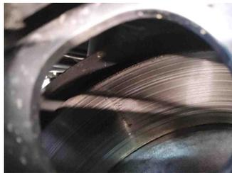
3 - Bremsbeläge hinten - Verschlissen - Ersetzen
