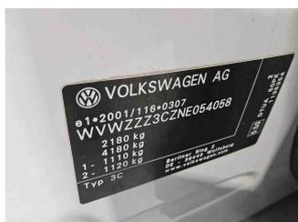
Fahrzeug - Typenschild/Fahrgestellnummer
